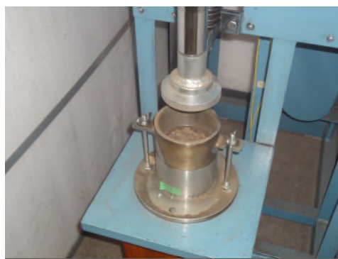
写真-2 供試体の作製状況
