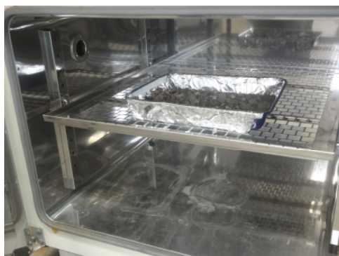
写真-1 アスファルト廃材の加熱状況
