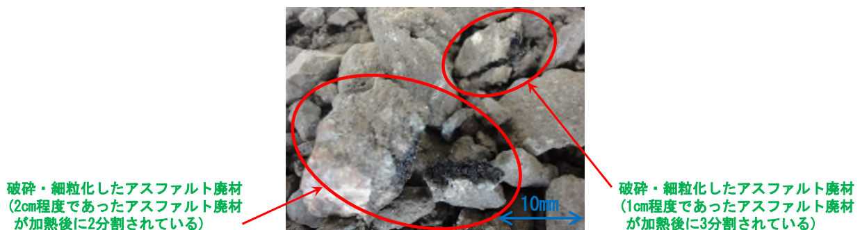
写真-3 加熱後のアスファルト廃材
