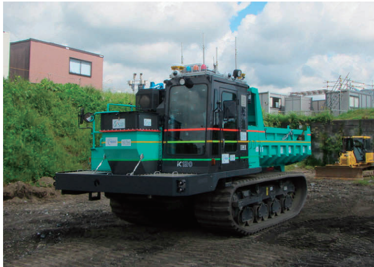
図-5.3-1 半水中遠隔操作型クローラダンプ (2号機)
