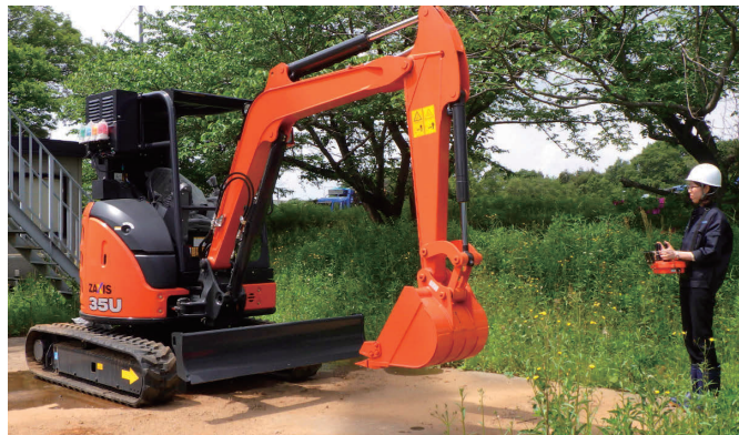
図-5.3-3 遠隔操作型小型油圧ショベル
