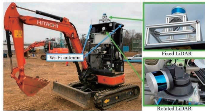
図-5.2-5 SLAM システムを搭載した遠隔操作型油圧ショベル
