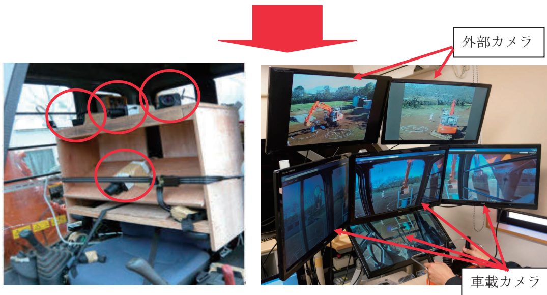
図-5.1-2 搭載した車載カメラ4台
