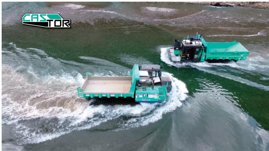
図-5.3-2 河川工事での運用 (水深約 2m)
