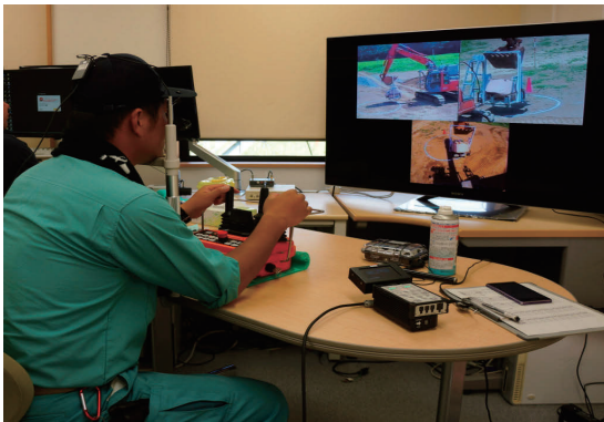
図-4.2-1 カメラ映像方式遠隔操作
