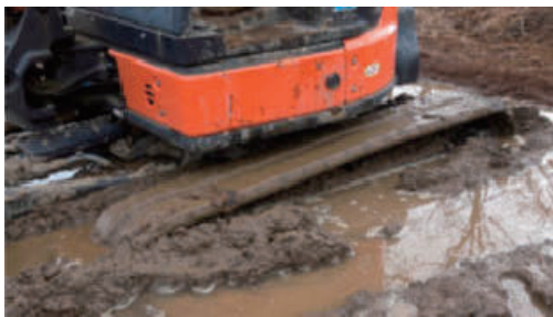
図-4.6-2 車両底面が地盤に接触した状況
