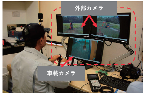
図-4.3-1 カメラ映像方式遠隔操作
