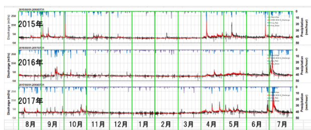
図-8 WEB-DHM-Sの検証結果(2013年10月-2015年9月の2年間のキャリブレーションで得られたパラメータを用いて2015年10月-2017年9月に適用し検証した結果)。上からハイドログラフ・積雪面積率(いずれも黒線が観測値、赤線が推定値)、積雪面積分布の衛星観測値、推定値。
