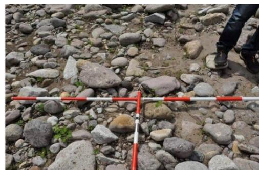
図-7 川俣ダム流域内 (O3 近傍) における河床材料調査
