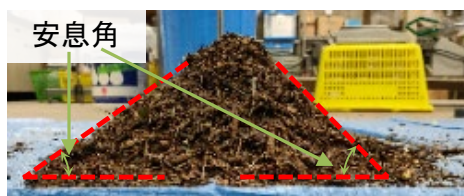
図-15 (b) 破碎機通過後草木破碎物の安息角
