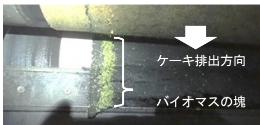
(a) 排出部のろ布サイドの脱水ケーキの様子 (バイオマスが端にたまっている)
