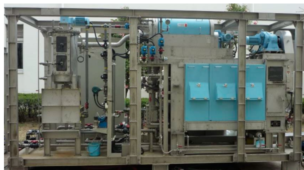
写真-2 圧入式スクリープレス脱水機 (脱水部スクリーン径 φ300 mm)
