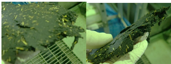
(b) 脱水ケーキ中にバイオマスが混合されている様子 写真-4 脱水ケーキの様子
