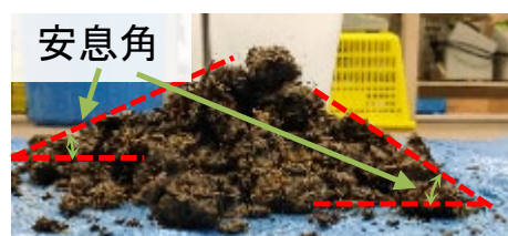
図-15 (a) 破碎機通過後し渣の安息角
