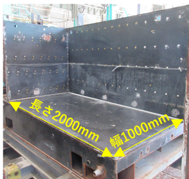
a) 型枠の状況
