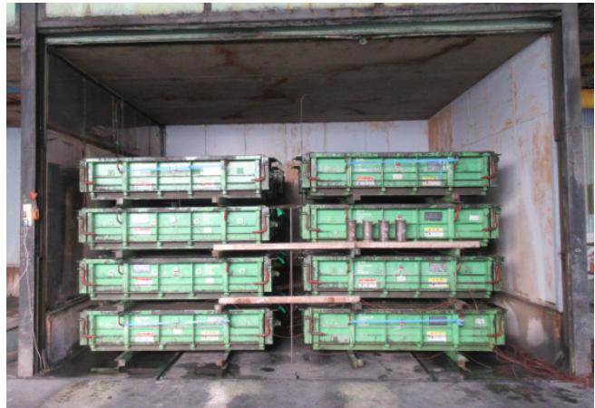
図 2-7 フリーム試験体を用いた実験における蒸気養生設備の正面写真
