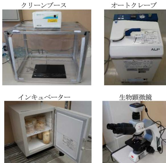
図-3 白色腐朽菌培養資機材の例<sup>12)</sup>
