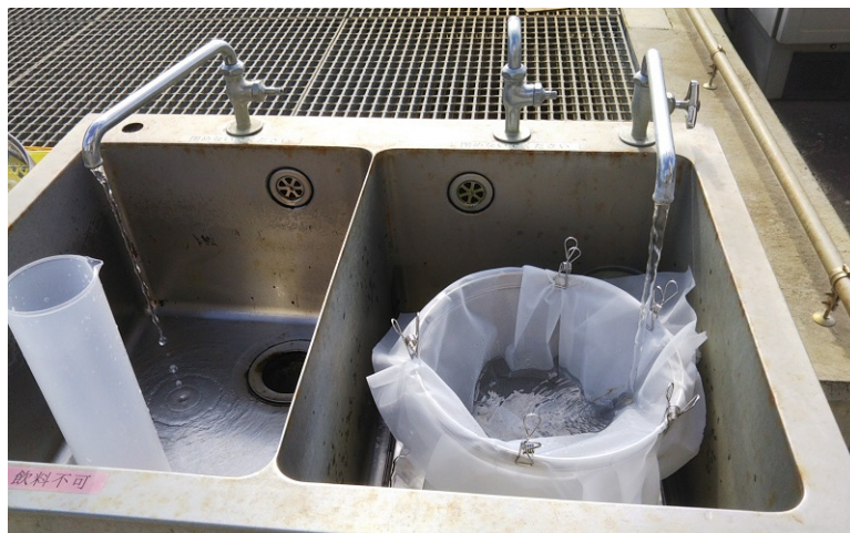
図-3.3 放流水の採水設備からの採水の例
