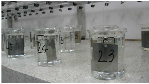
写真-1 金属腐食試験実施状況
