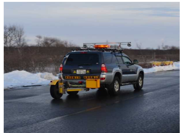
写真-4 連続路面すべり抵抗値計測装置
