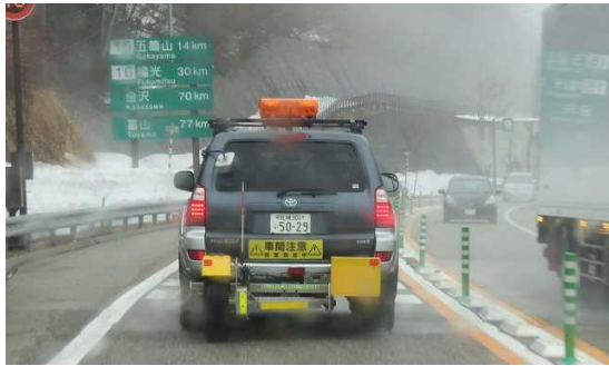
写真-5 すべり抵抗値計測状況
