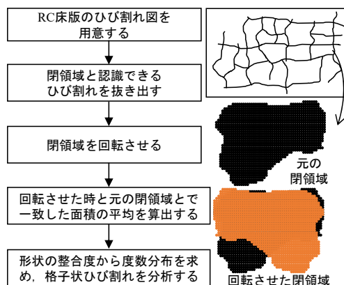
図-6 格子状ひび割れの分析フロー
