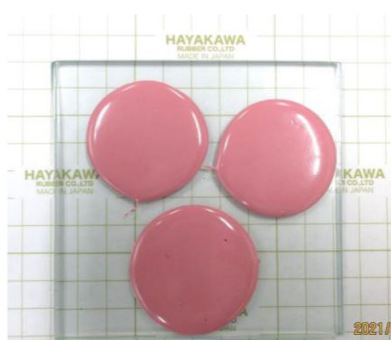
写真-3.2.4 指触乾燥試験後の外観（接着剤）
