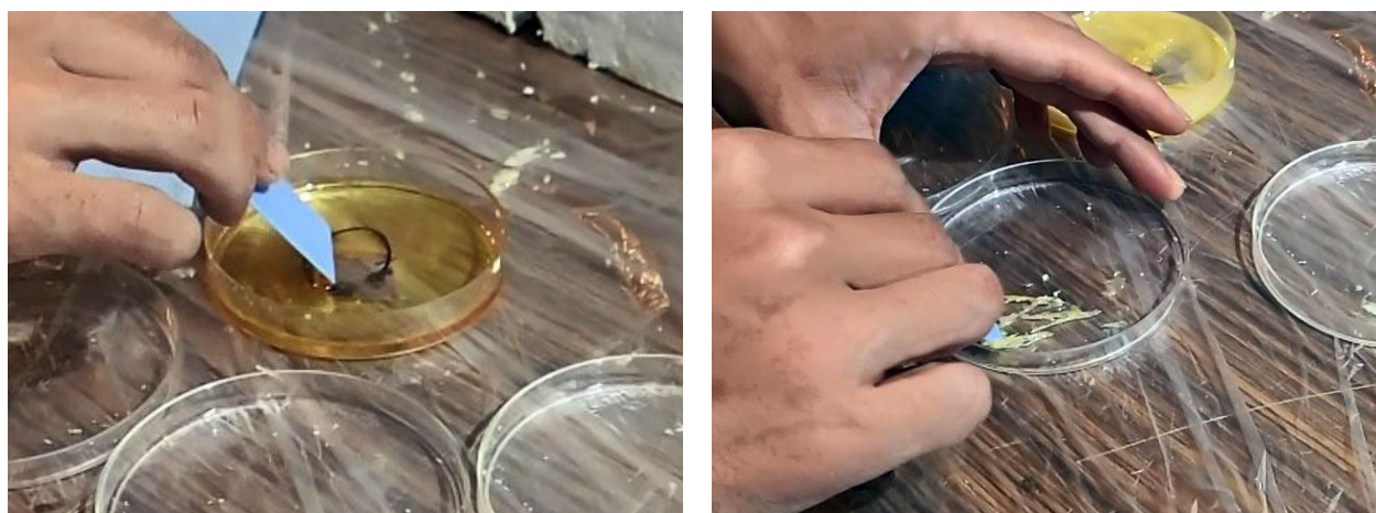
写真-付 2.1.3 判定時の状態 (左：可使時間外 右：整形不可能)
