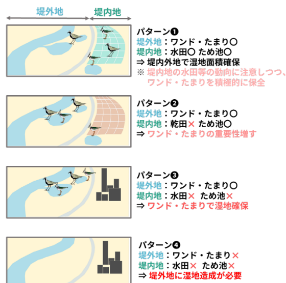
図-26 堤外地（河川域）と堤内地の状況を踏まえた湿地面積確保の考え方。セグメント2（自然堤防帯）を想定。
