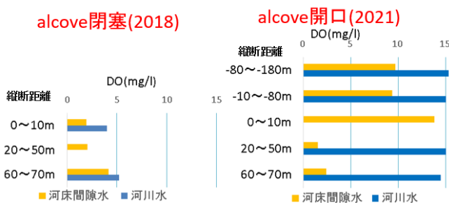
図-11 開口前後のDOの比較 (縦断距離の内マイナスは小規模掘削路区間)
