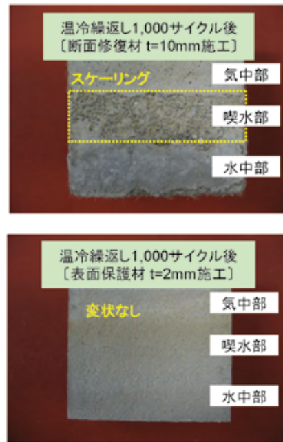
写真-3.4 温冷繰返し1,000サイクル後の喫水部に配置した補修供試体の表面 (供試体のサイズ: 縦7cm×横7cm)
