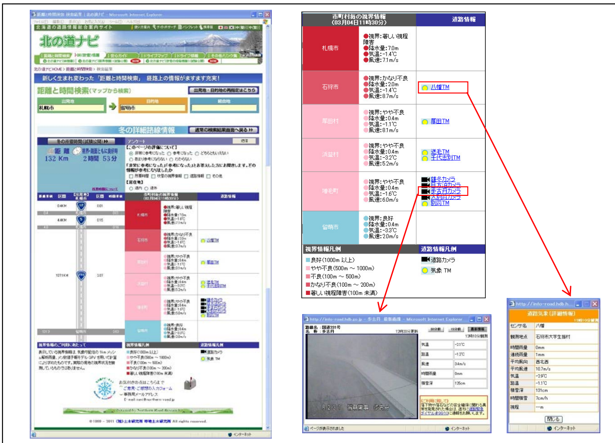
図-5.16 「冬の詳細路線情報」の提供画面と情報コンテンツ(パソコン版) (吹雪の視界状況(右上)、道路の気象テレメータ(右下(左))、道路画像(右下(右)))
