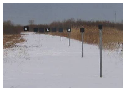
写真-5.1 視程板の設置状況
