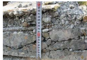
写真-5.1 実験後の A 橋の試験体切断面
