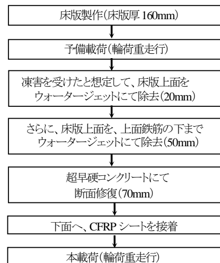
図-5.8 補修・補強実験フロー
