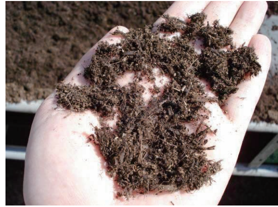
写真-5.3 蒸煮爆砕処理物
