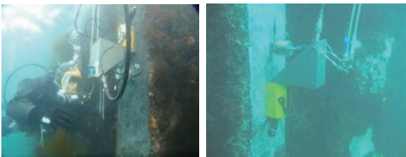
写真-5.3 潜水士による測定（左）、治具（右）
