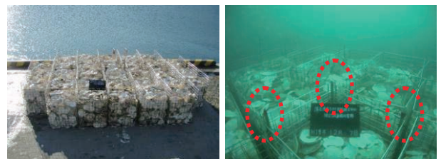
写真-4.7 実用に向け規模拡大した貝殻礁 左側：貝殻礁全景 右側：設置状況（丸印が採水パイプ）
