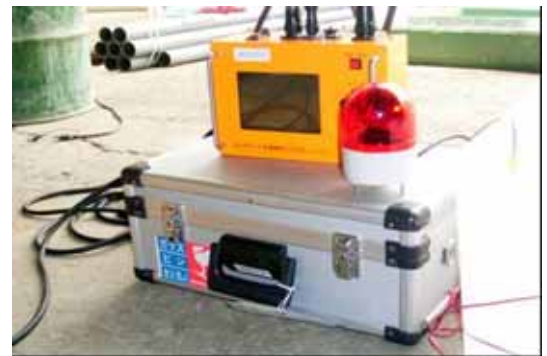
写真4.2.7 ロガー及び警報用パトランプ
