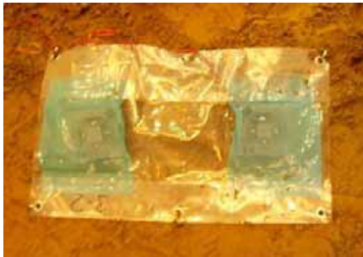
写真4. 2. 52 シート型センサ設置状況
