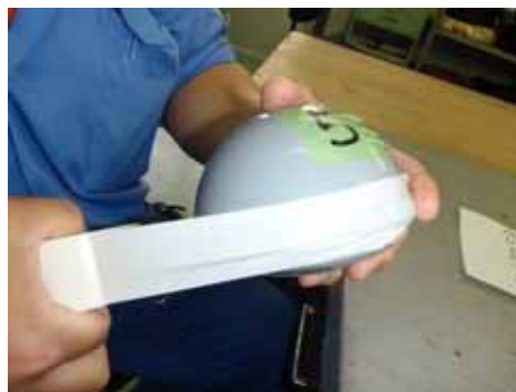
写真 4.6.16 センサ容器防水処理加工
