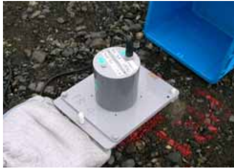
写真 4.5.2 受信アンテナ外観
