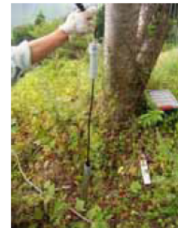
写真 4.1.20 単管打設型地上設置タイプ (ID:19C) 設置状況
