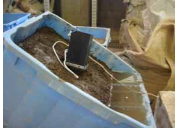
写真 4.3.18 設置の様子 (土、含水、35°)
