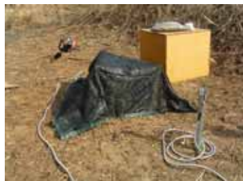
写真 4.1.12 IT地表面傾斜計設置状況
