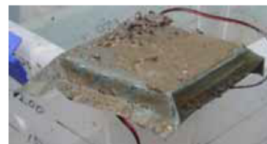
写真4.2.41 実験後のフィルター状況 粗い目
