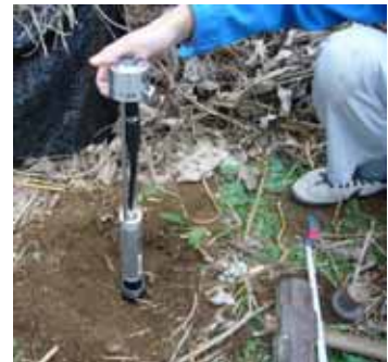
写真 4.1.18 単管打設型深入設置タイプ設置状況
