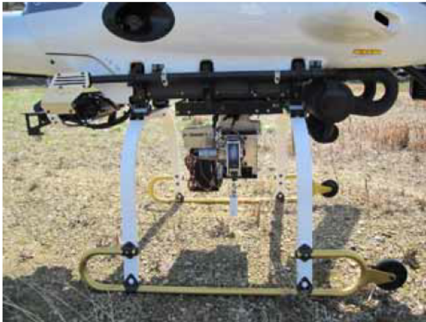
写真 4.3.30 ラジコンヘリに取付けた投下装置
