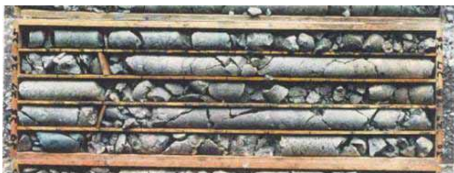
写真 5.1 破碎されている凝灰岩(D級)
