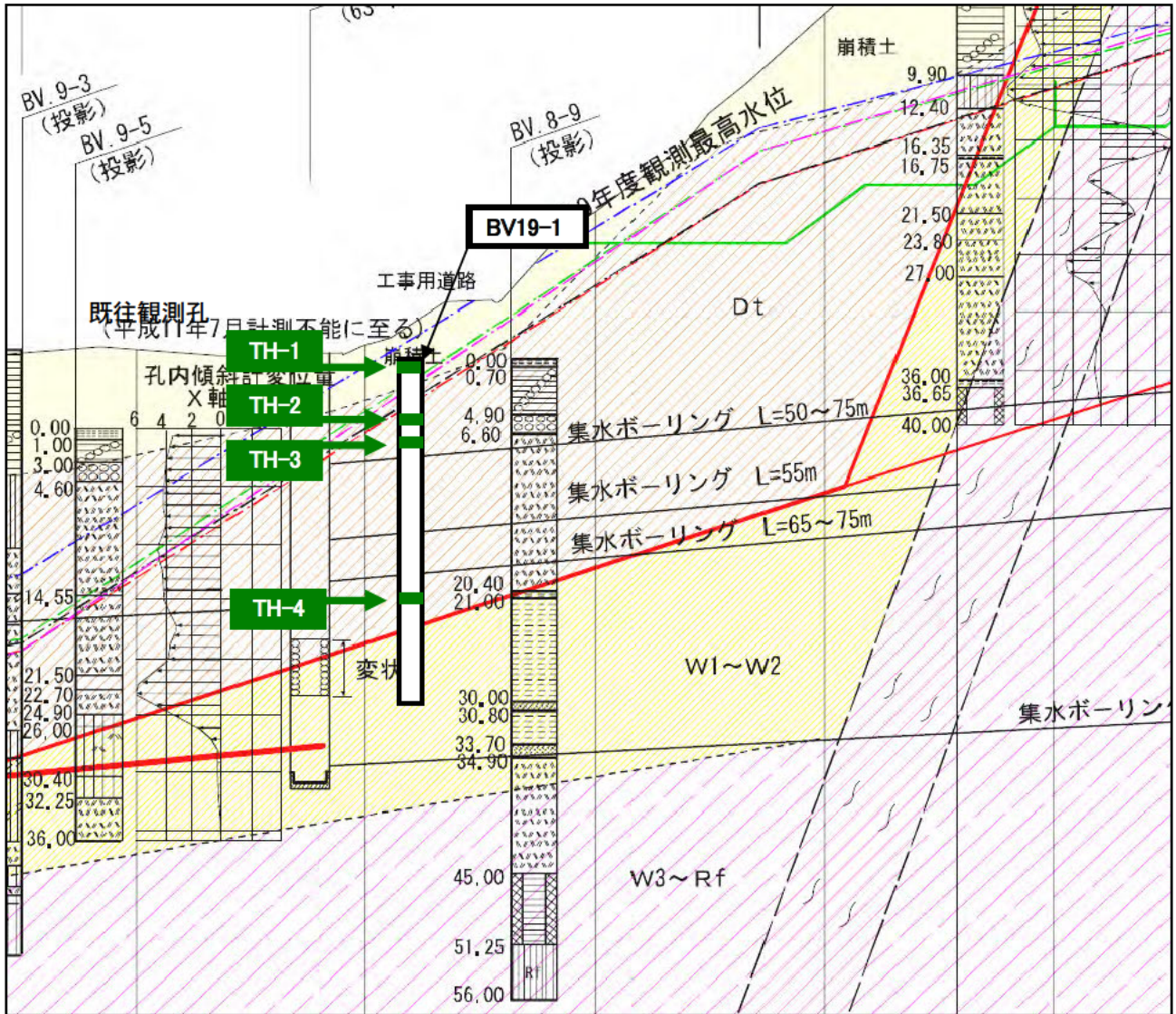
図 4.60 層別沈下計設置深度(拡大図)
