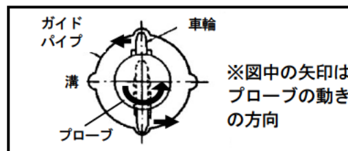
図 2.36 測定中のガイド管とプローブを上方から見た図
