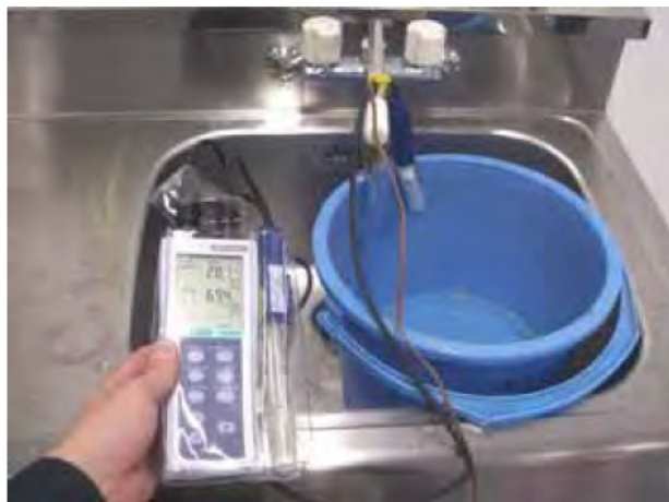
写真3.2 水温を変化させた較正作業
