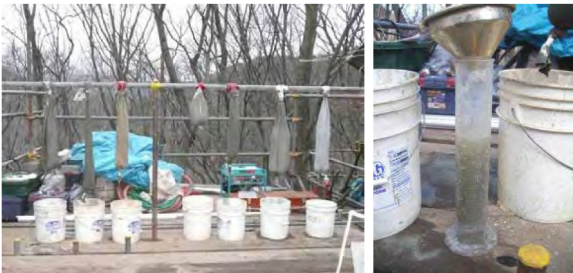
写真 4.5 パッカー試験の実施状況および漏出量の測定状況
