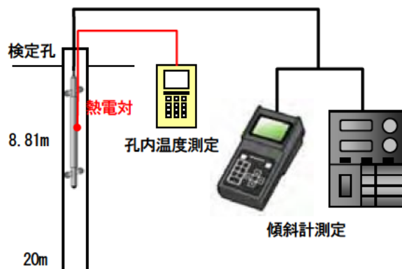
図 3.23 孔内水の影響実験の模式図 (室内実験、応用地質(株)製)
