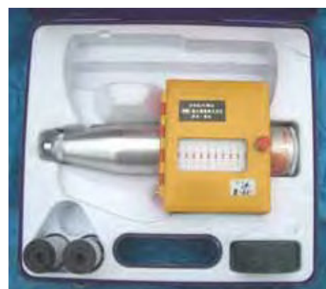
写真 4.8 コンクリート用シュミットハンマー（富士物産㈱製）
