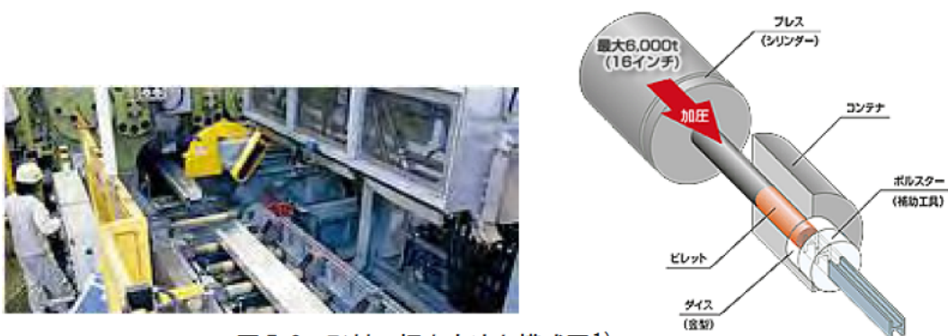
図 5.3 型材の押し出し方法と模式図 1)
