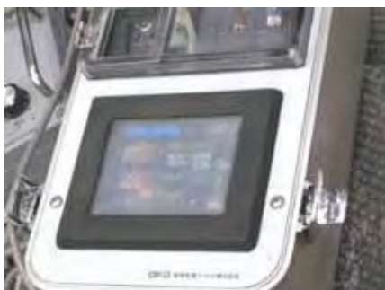
孔曲がり測定器(改良) 応用計測サービス製
