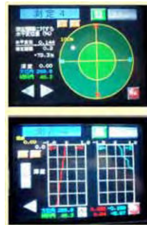
図 4.82 孔曲がり測定器 (応用計測サービス株製、従来品を改良、マグネットメーター式)
