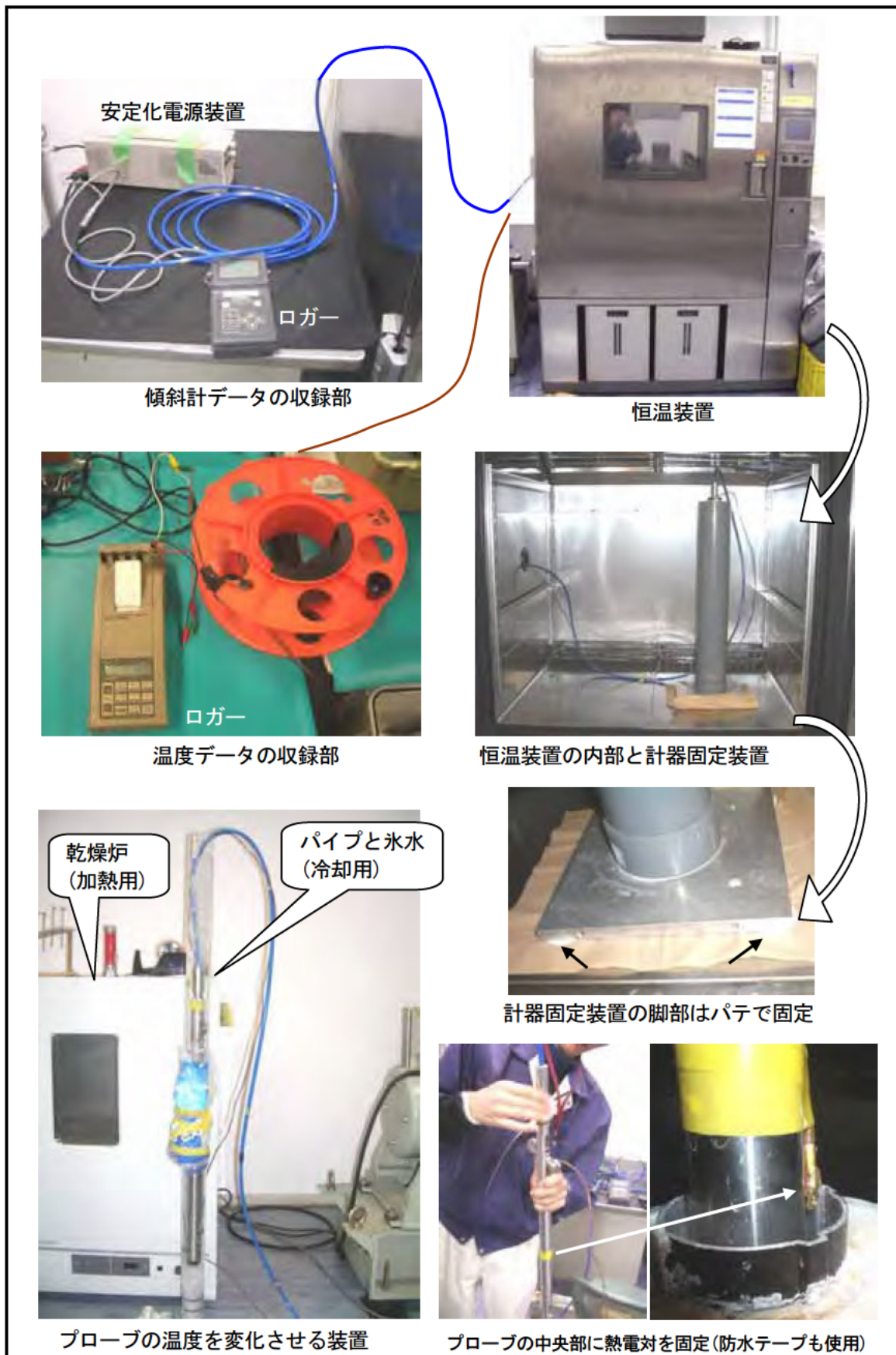
写真 3.3 使用機材の写真
