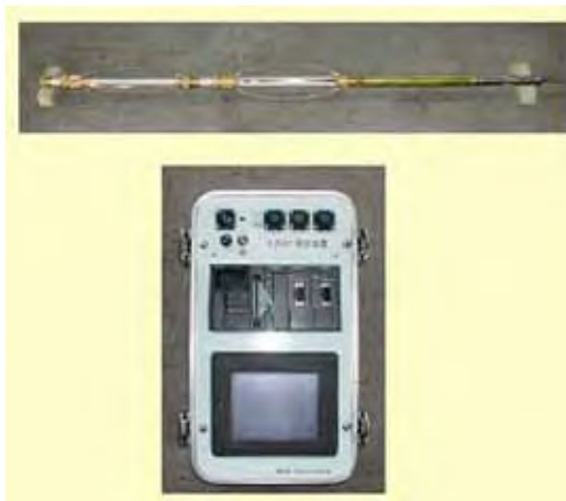
図 4.82 孔曲がり測定器 (応用計測サービス株製、従来品を改良、マグネットメーター式)
