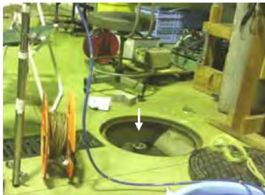
写真 3.9 測定孔の状況 (応用地質(株)の検定孔、ステンレスケーシング)
