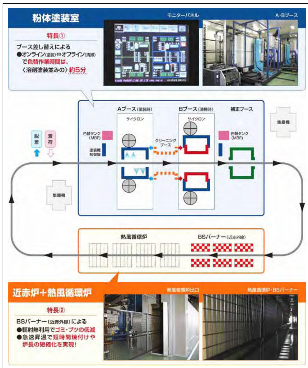
図 5.7 粉体塗装の工場のライン 2)
