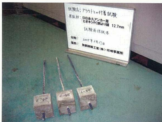
写真5 グラウト 23 N/mm 2 付着試験前供試体
