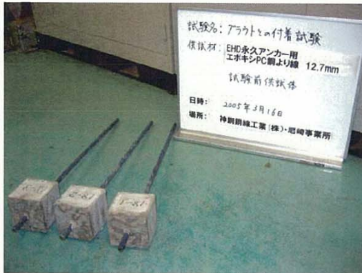
写真1 グラウト 17 N/mm 2 付着試験前供試体
