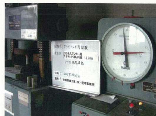
写真6 グラウト強度確認試験
