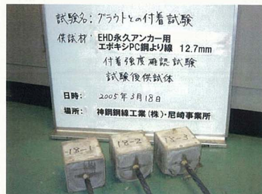
写真4 グラウト 17 N/mm 2 付着試験後供試体
