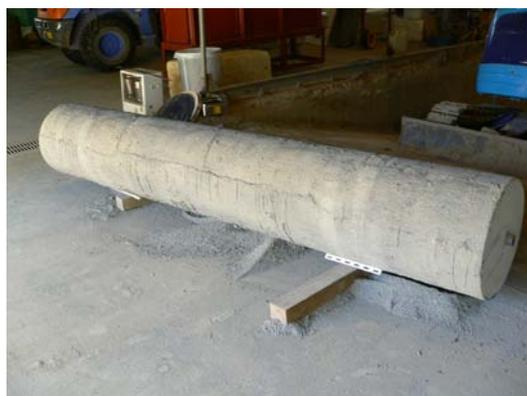
(b) 拡径型アンカー模型（川砂貼り付け完了）
