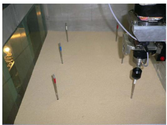
写真 3-5 地盤作製完了後 (アンカー傾角  $90^\circ$ )
