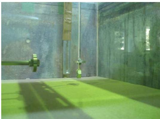
写真 3-2 アンカープレート模型の設置 (アンカー傾角  $0^\circ$ )
