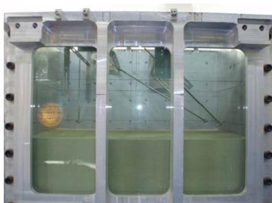
写真 3-3 アンカープレート模型の設置 (アンカー傾角  $30^\circ$ 、 $45^\circ$ )
