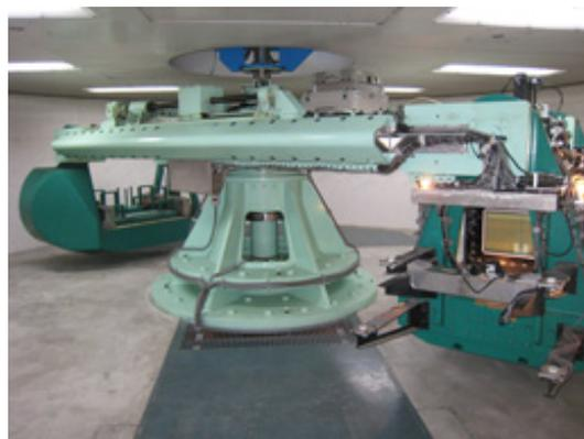
写真 2-1 遠心力载荷試験装置
