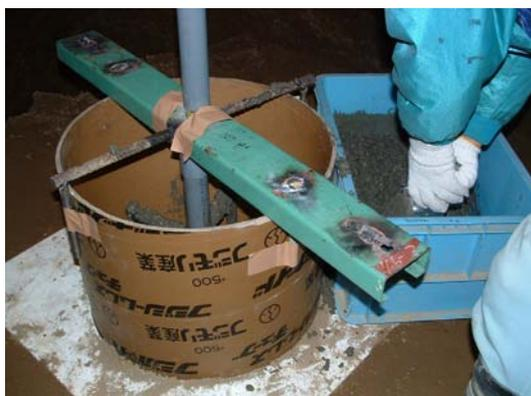
(a) 拡径型アンカー模型打設状況
