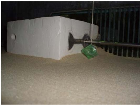
写真 2-9 アンカー模型と治具（石膏）の設置
