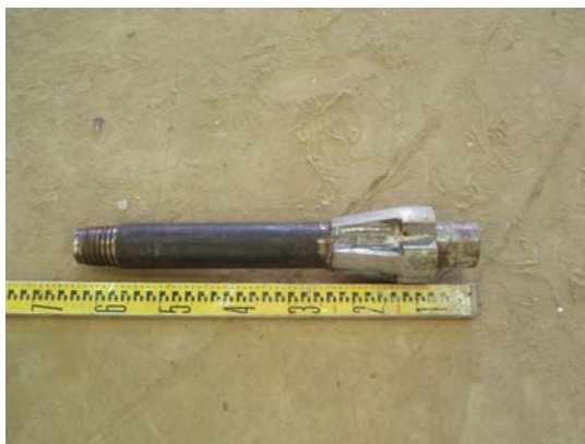
写真-2.4 圧入管先端部
