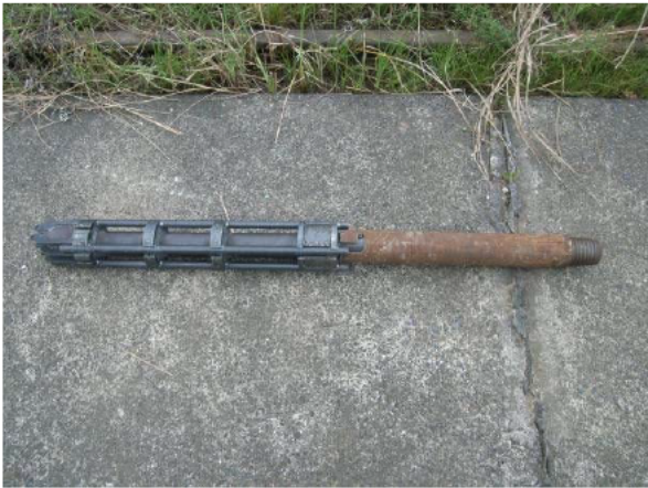
耐荷体+圧入管接続状態
