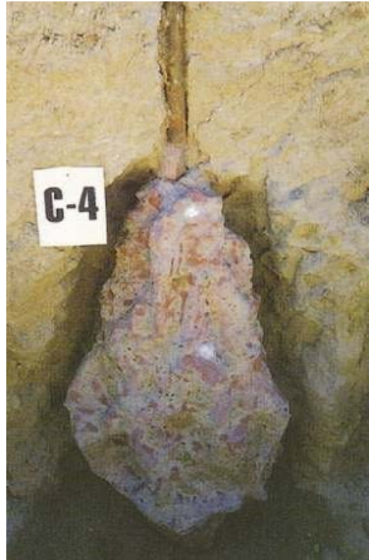
図-1.4 CPG 工法 固結体出来形
