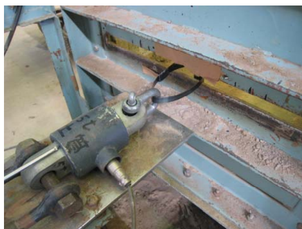
写真-2.16 固定用バンド引張り試験
