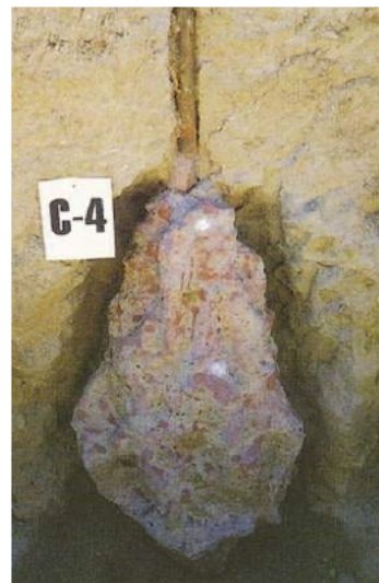
図-1.4 CPG 工法 固結体出来形
