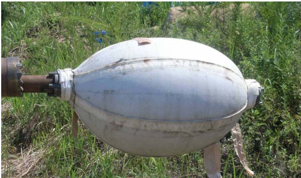
写真-3.3 耐荷体拡張状況
