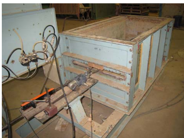
写真-2.16 固定用バンド引張り試験
