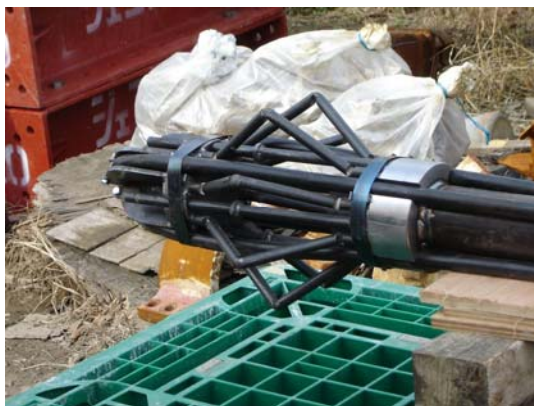
写真-2.6 気中拡大試験 (先端側)
