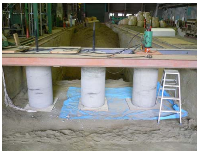
写真-2.10 簡易引抜試験 試験状況
