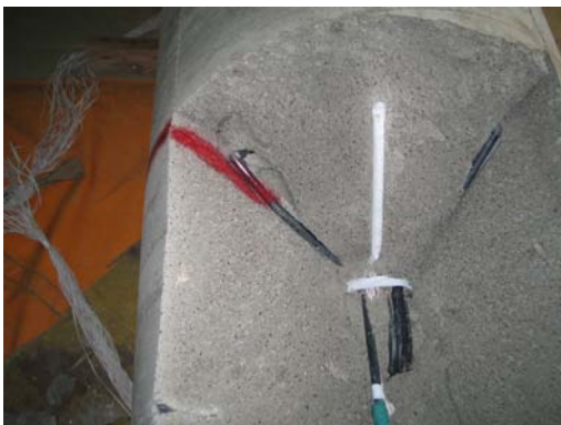
写真-2.11 引抜試験後の状況
