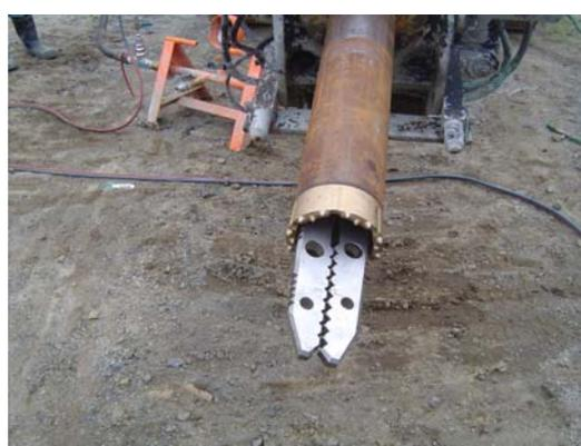
図 5.9 回収型拡径ビット
