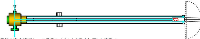
⑦ 拡張部の造成(削孔) 二重管スイベルから送水加圧した状態で、インナー、外管共に回転させながら、所定長削孔する。
