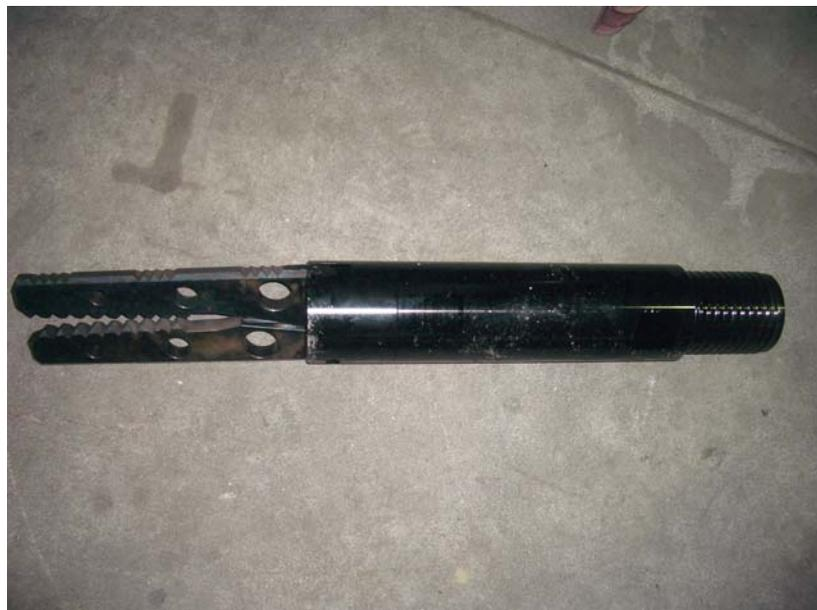
図 2.3 回収型拡張ビット (閉じた状態)
