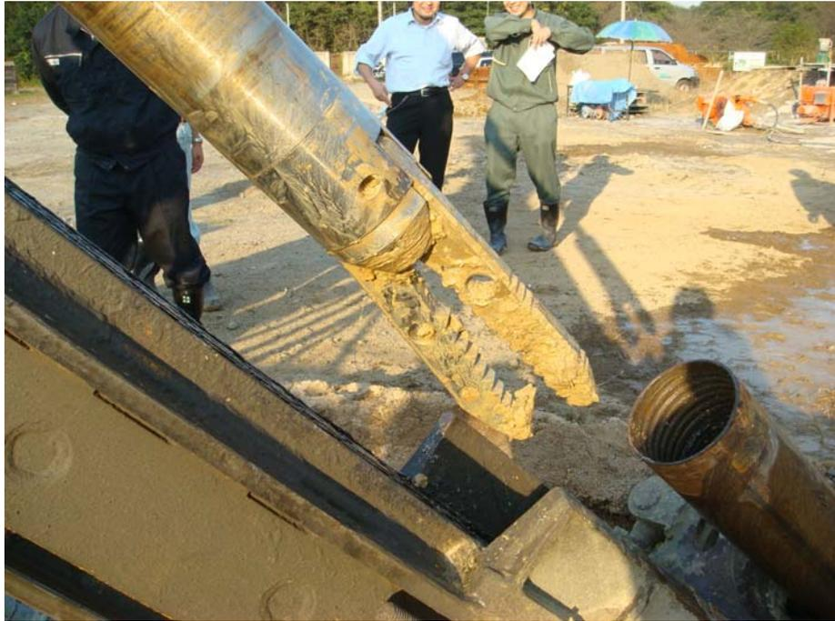
図 2.16 拡径削孔後のビット
