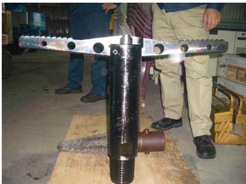
図 2.4 回収型拡張ビット (開いた状態)
