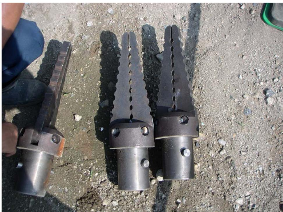
図 5.6 残置式拡径型ビット (1)
