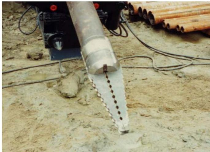
図 2.1 残置式拡径ビット
