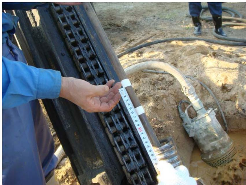
図 2.15 ビットが開いた状態（ピストンのストローク測定（6.5cm））
