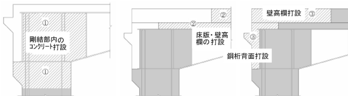
図 3.2.2 上・下部構造接合部の分割施工例
