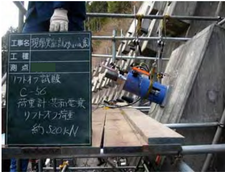
写真 10.54 リフトオフ試験結果
