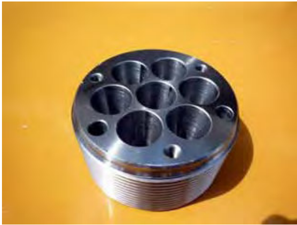
写真 10.75 ジョイントスリーブの上面
