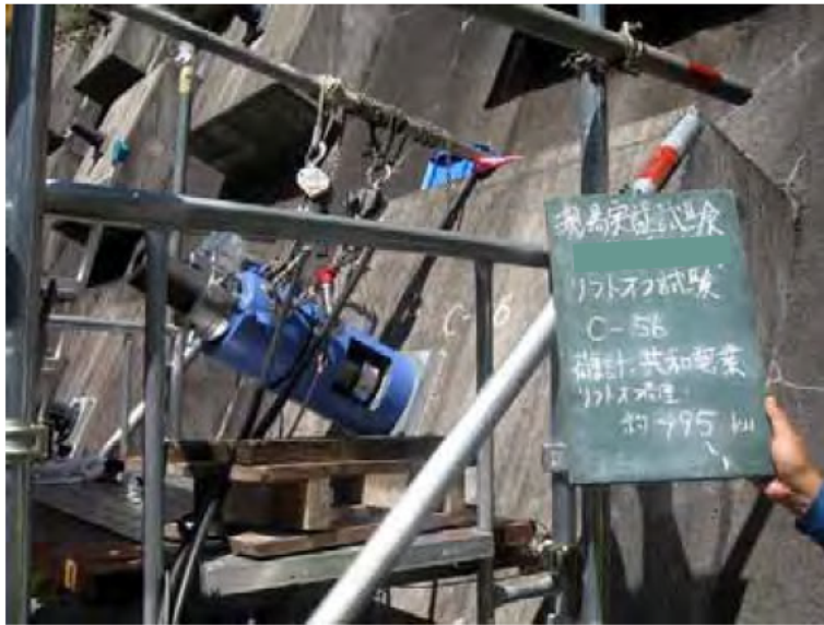
写真 10.81 リフトオフ試験結果
