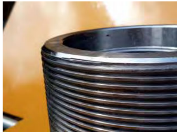
写真 10.78 テンションスリーブ ネジ部の変形
