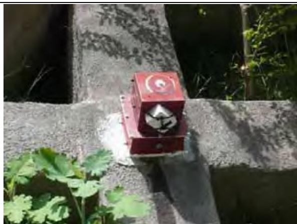
図 10.57 設置時と撤去時のデータ送信ユニット外観 (1/2)
