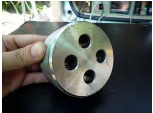
写真 10.41 ジョイントスリーブの底面
