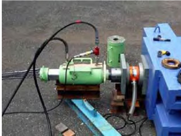
写真 11.33 模擬緊張用ジャッキ側のセット状況
