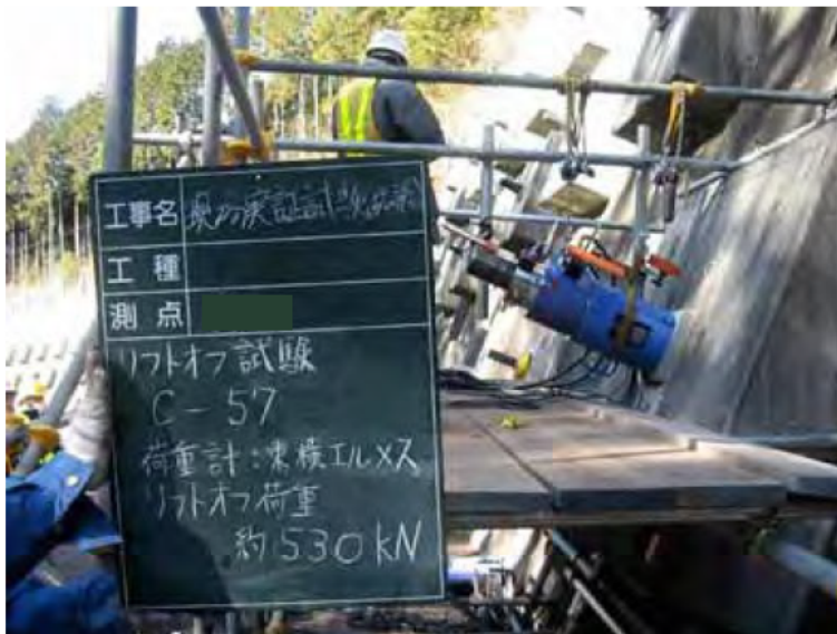
写真 10.55 リフトオフ試験結果
