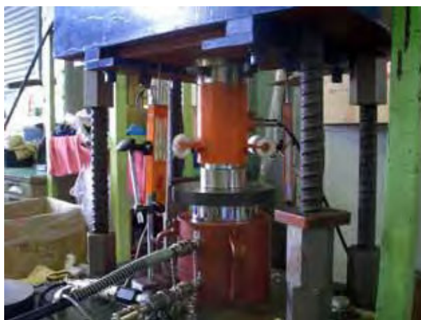
写真 4.4 ジャッキ校正試験状況（複動式ジャッキ）
