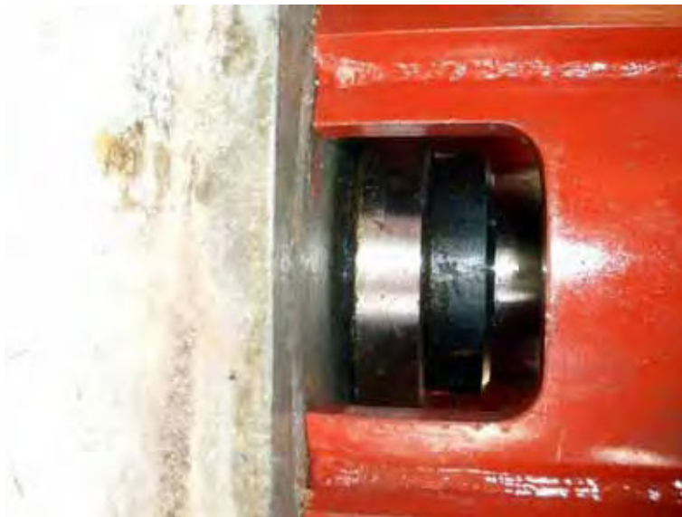
写真 10.31 リフトオフ後 のアンカーヘッド (支圧板からジョイントブ レートが浮いている)
