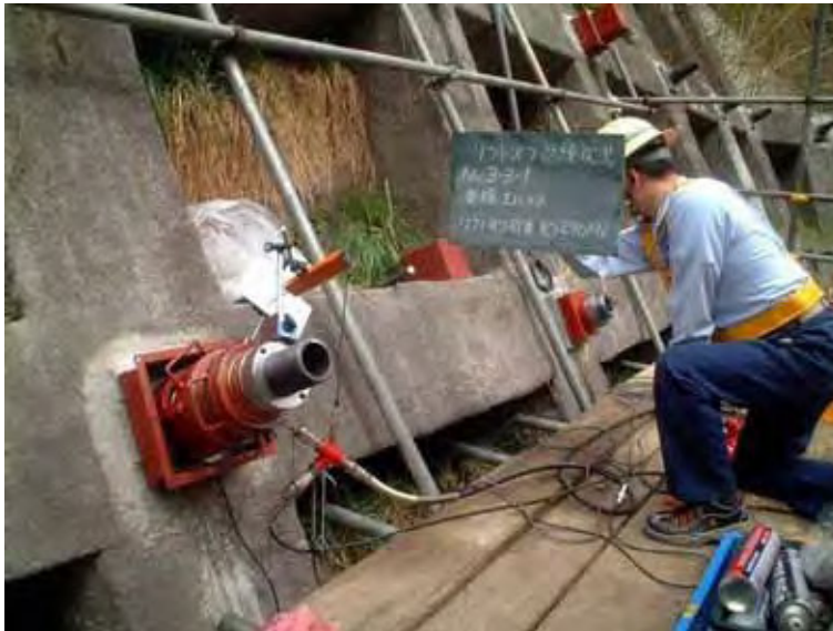
写真 10.10 リフトオフ試験結果
