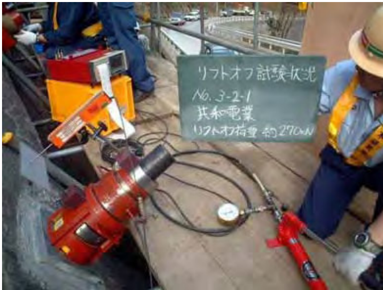
写真 10.7 リフトオフ試験結果
