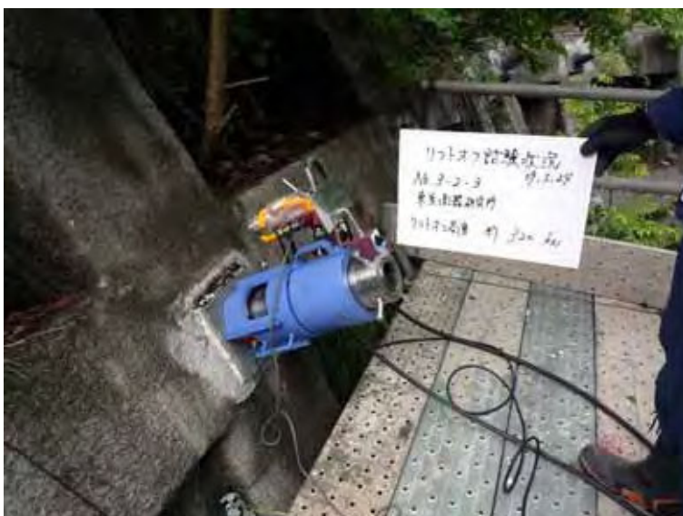
写真 10.48 リフトオフ試験結果
