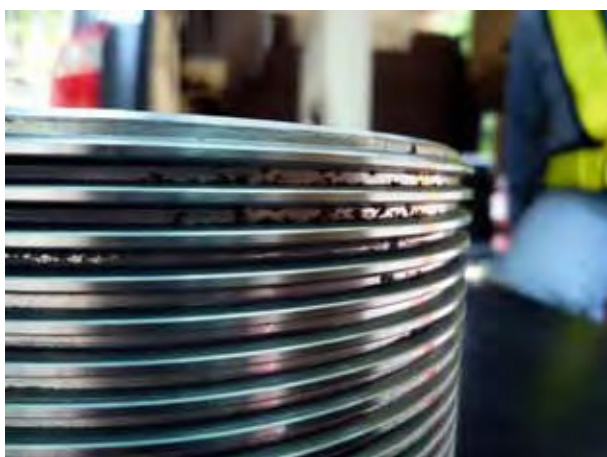
写真 10.44 テンションスリーブのねじ山内部
