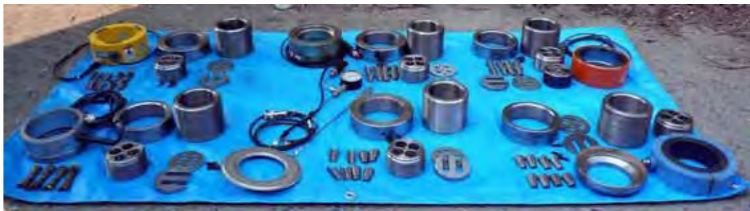
写真 10.39 荷重計取外し後の緊張治具
