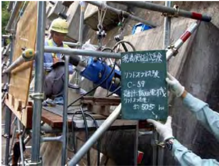
写真 10.84 リフトオフ試験結果
