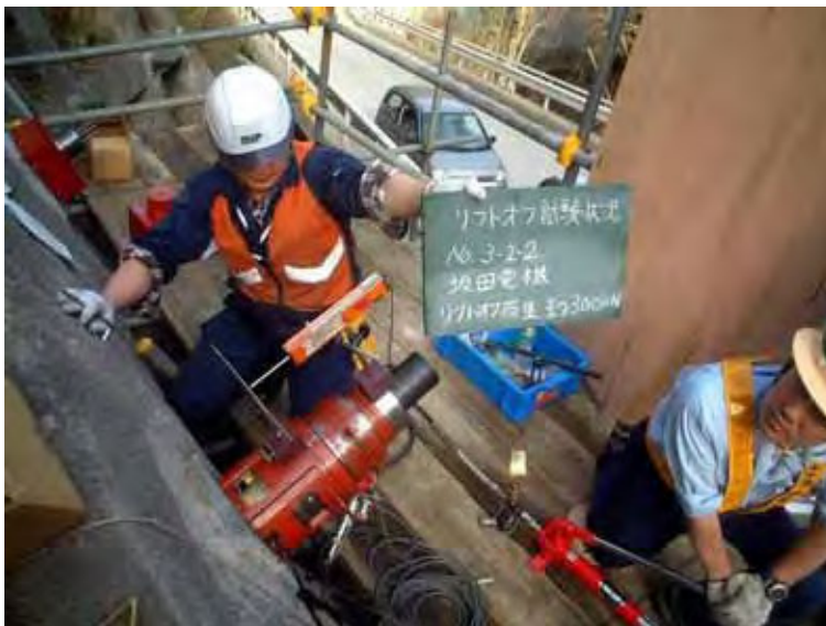
写真 10.8 リフトオフ試験結果
