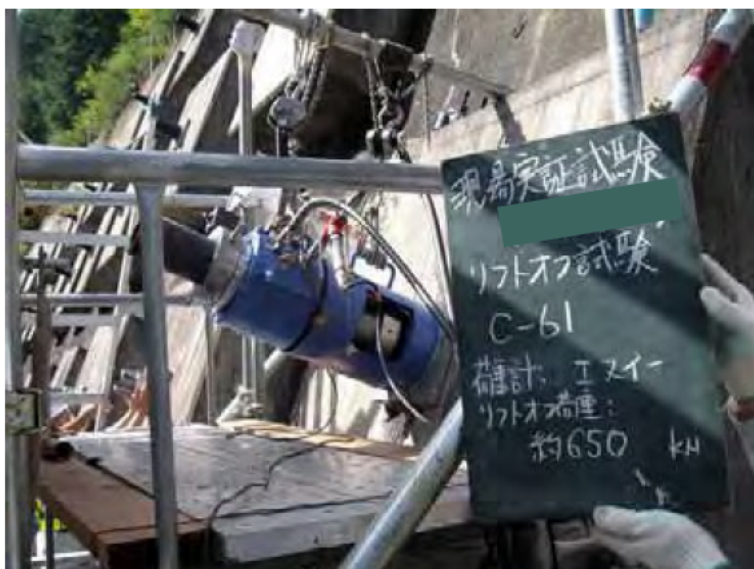
写真 10.86 リフトオフ試験結果
