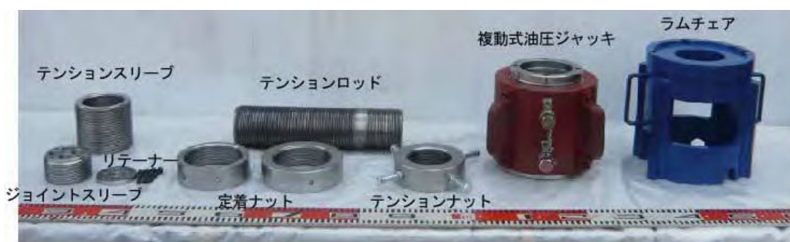
写真 4.3 緊張治具一式（複動式油圧ジャッキ）
