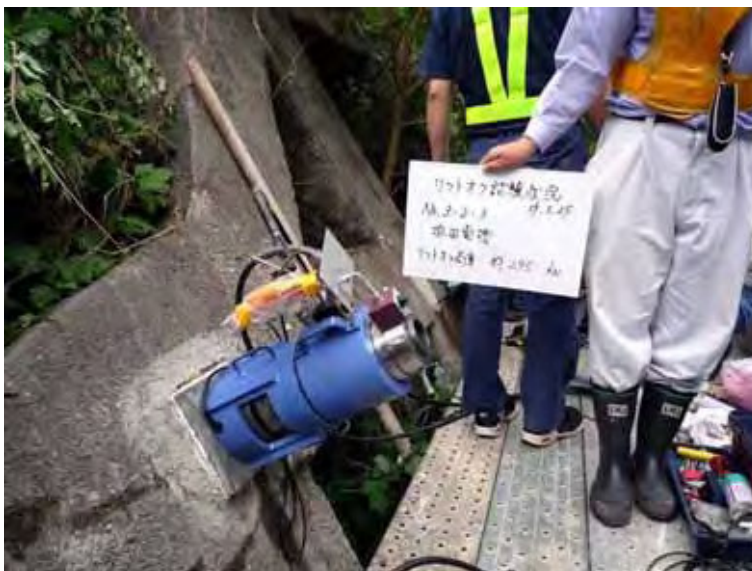
写真 10.47 リフトオフ試験結果
