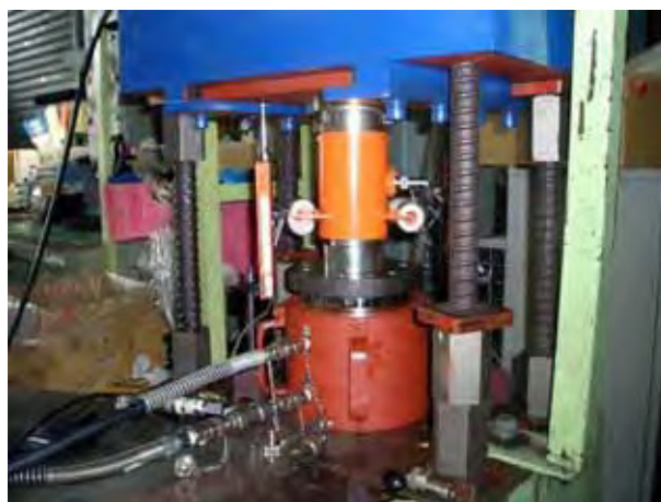
写真 7.2 ジャッキ校正試験状況
