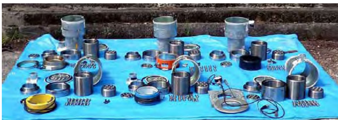
写真 10.74 荷重計取外し後の緊張治具
