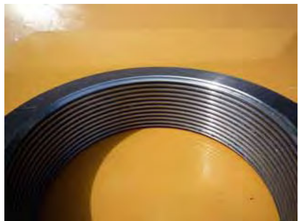
写真 10.80 定着ナットの内側ねじ部
