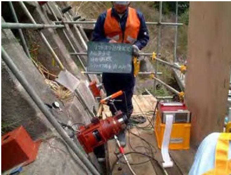
写真 10.11 リフトオフ試験結果
