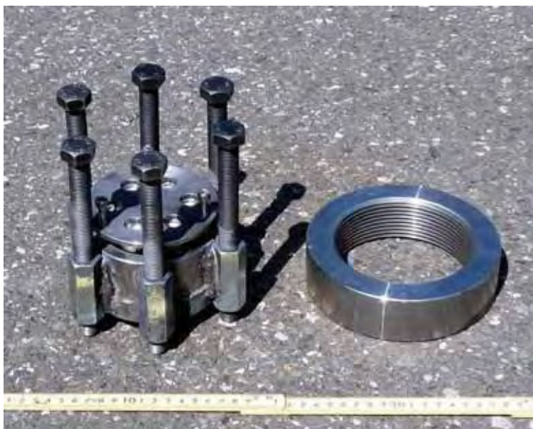
写真 11.21 取外し治具（E5-7用）
