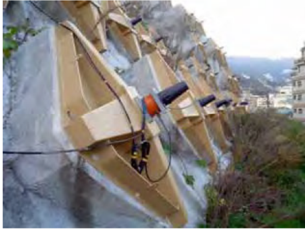
写真 1.3 荷重計の設置例
