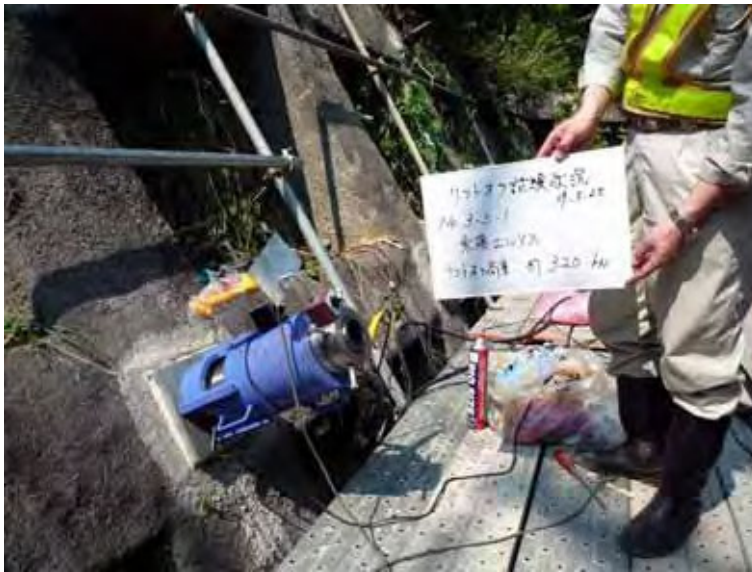
写真 10.49 リフトオフ試験結果
