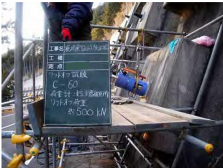
写真 10.58 リフトオフ試験結果
