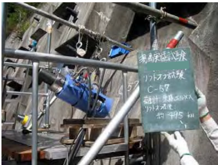
写真 10.82 リフトオフ試験結果
