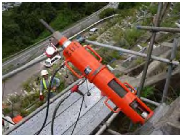
写真 1.2 リフトオフ試験の実施例
