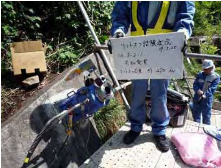
写真 10.46 リフトオフ試験結果
