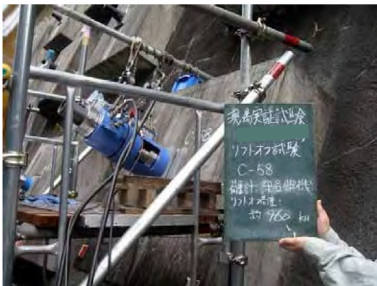
写真 10.83 リフトオフ試験結果
