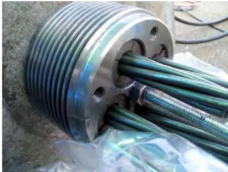
写真 11.20 最大載荷時のくさび状態
