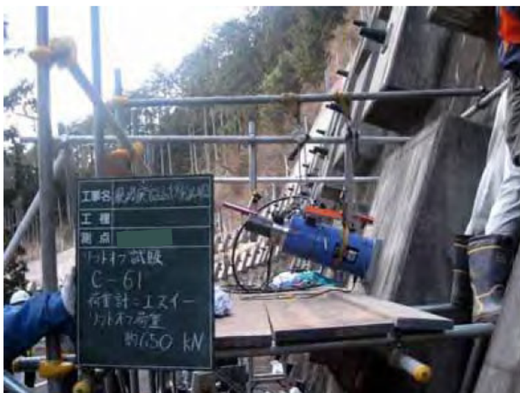
写真 10.59 リフトオフ試験結果
