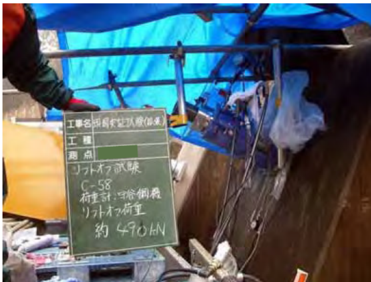
写真 10.56 リフトオフ試験結果
