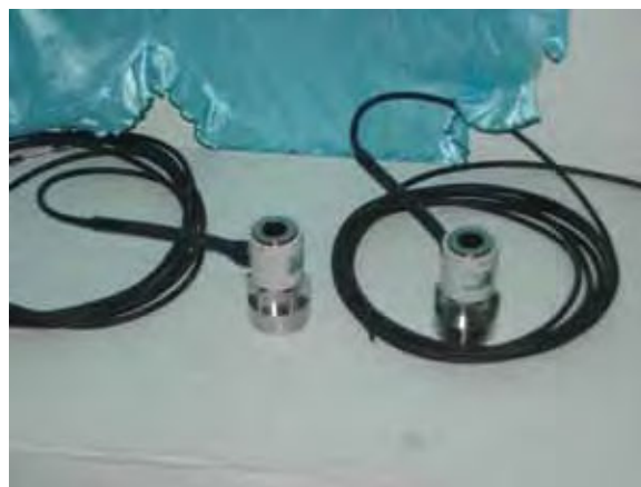
写真 11.11 斜材張力管理用荷重計（ひずみゲージ式荷重計）
