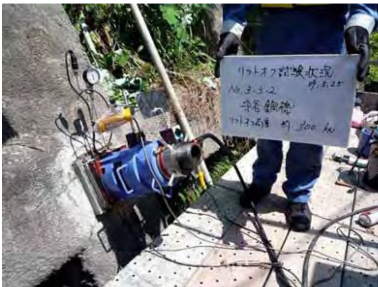
写真 10.50 リフトオフ試験結果
