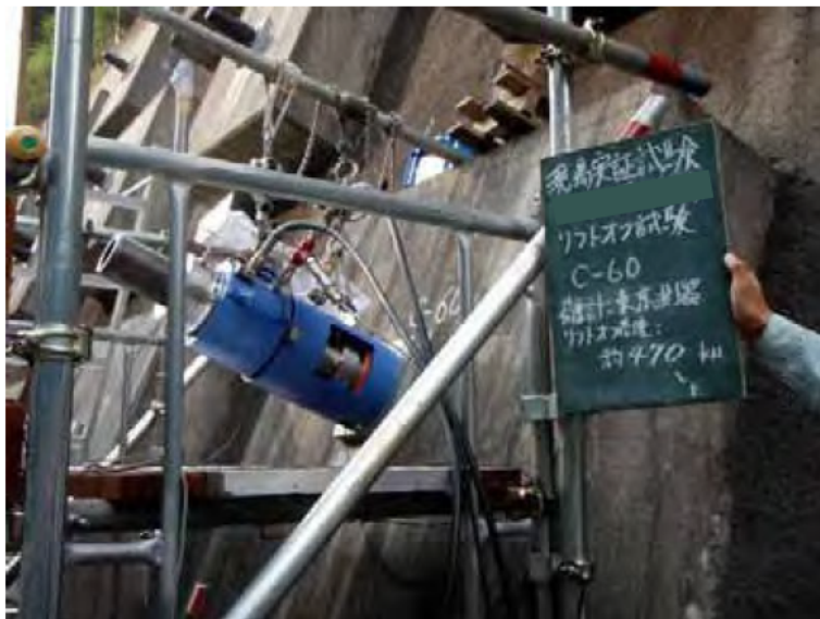
写真 10.85 リフトオフ試験結果
