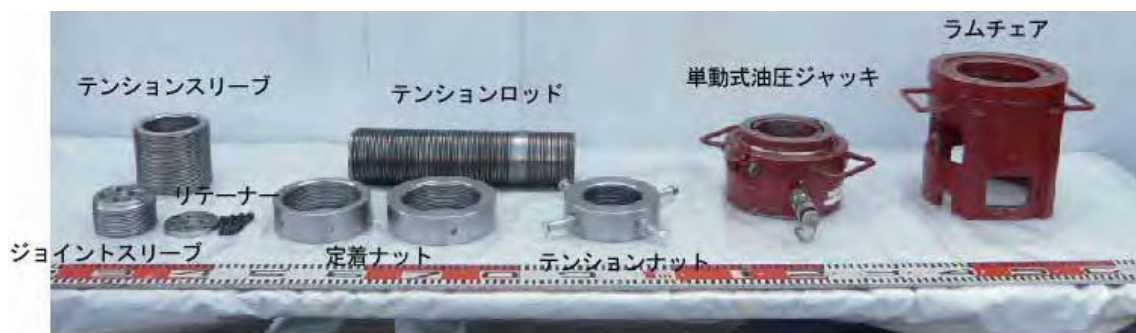
写真 4.2 緊張治具一式（単動式油圧ジャッキ）
