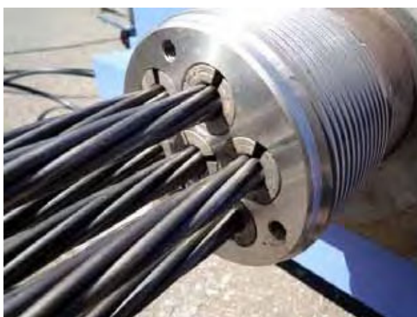
写真 11.24 ジョイントスリーブのくさび
