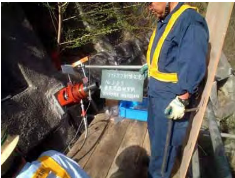
写真 10.9 リフトオフ試験結果
