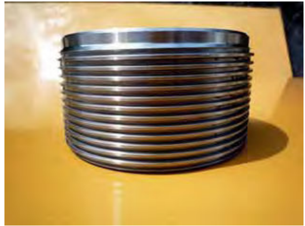
写真 10.76 ジョイントスリーブの側面
