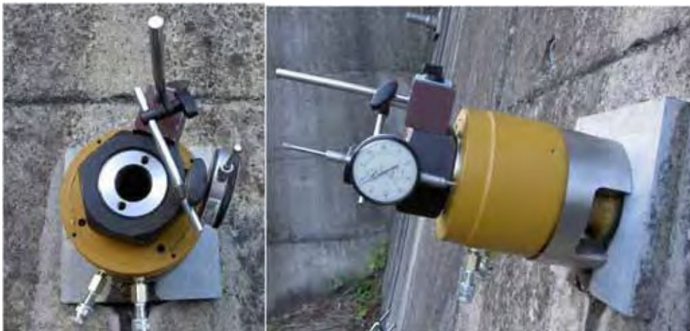
写真 11.8 軽量ジャッキのセット状況
