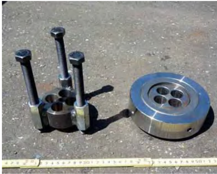
写真 11.22 取外し治具 (E5-4 用)
