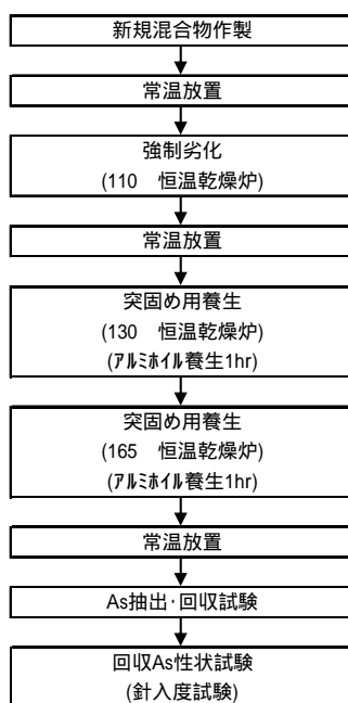
図-2.5 室内促進加熱劣化方法
