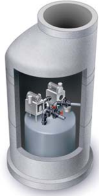
図2-7 小型真空（CP）ステーション概要図
