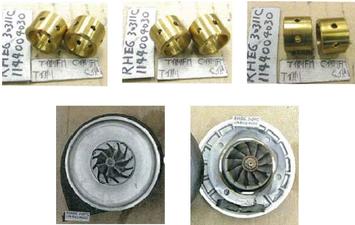
図-3.6.10 806 時間運転後の過給機の軸受および各インペラ外観
