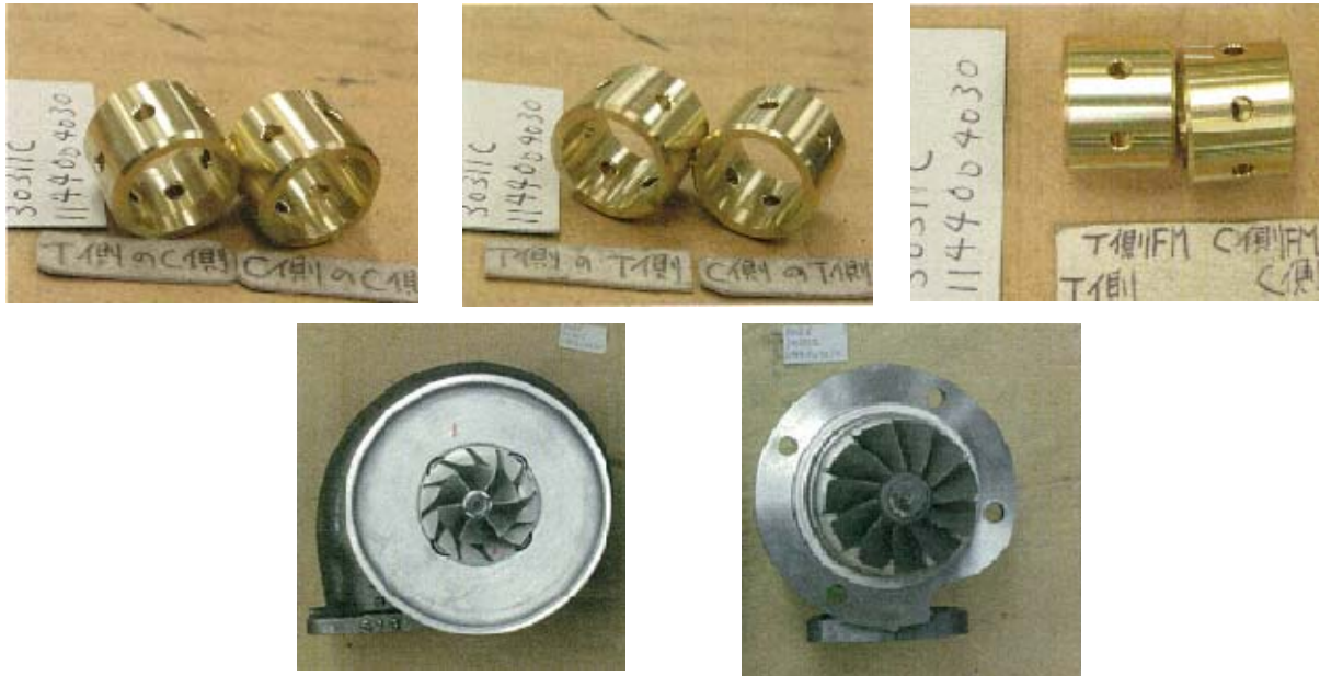
図-3.6.9 新規過給機の軸受および各インペラ外観
