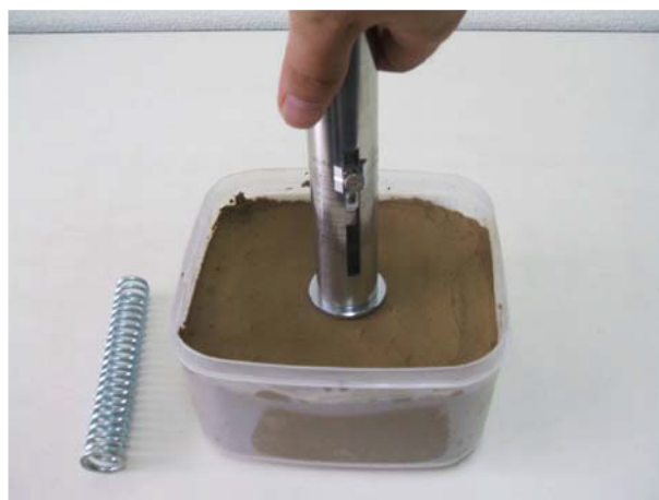
写真-5.2 一軸圧縮強さと貫入量の相関調査状況
