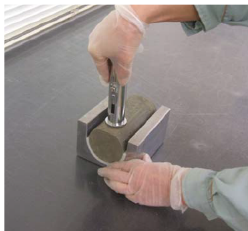
写真-5.2 一軸圧縮強さと貫入量の相関調査状況
