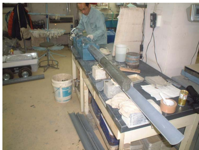
写真-1.2 コア脱型状況
