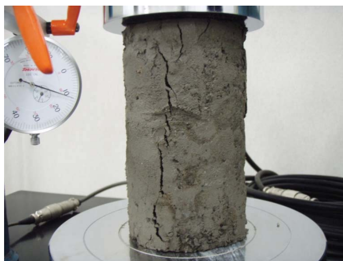
写真-2.3 一軸圧縮試験状況②
