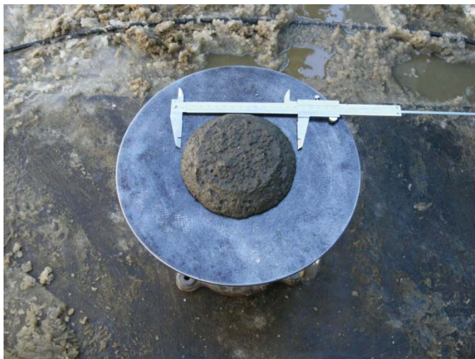
写真-2.6 テーブルフロー試験状況
