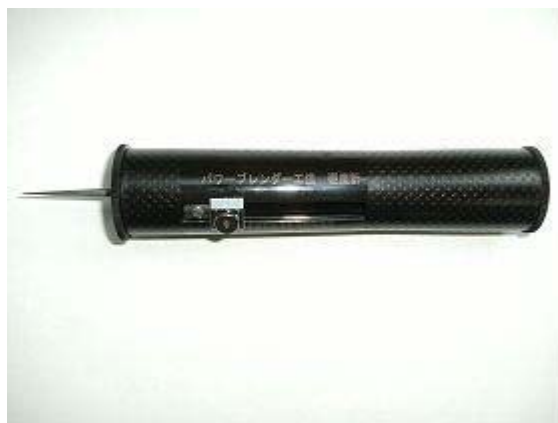
写真-2.2 改良型土壌硬度計
