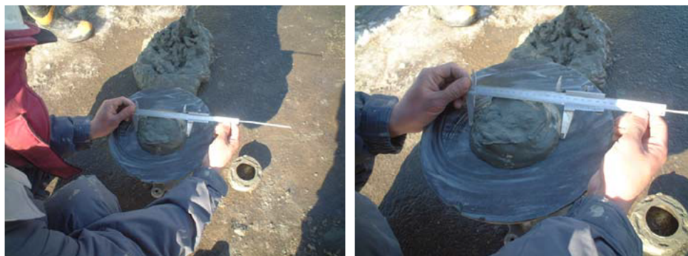
写真-3.5 テーブルフロー試験状況（パターン③）
