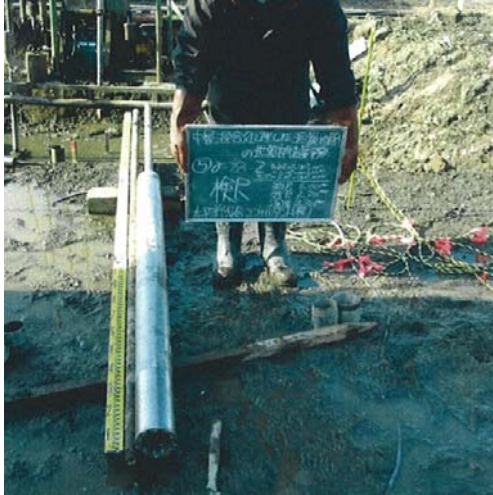
写真-4.8 トリプルチューブサウンディング作業状況
