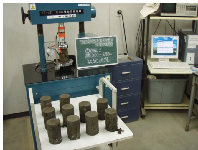
写真-2.2 一軸圧縮試験状況①
