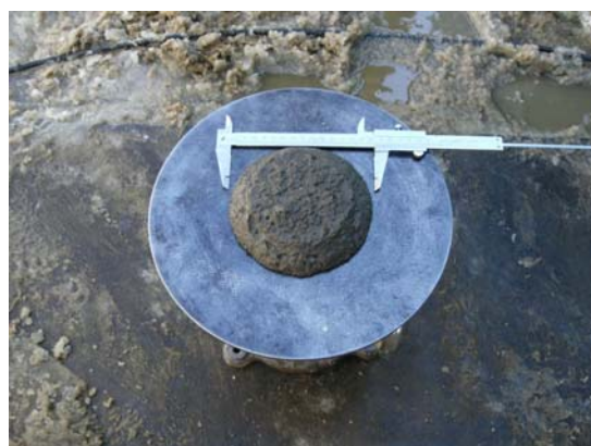
写真-4.5 テーブルフロー試験状況
