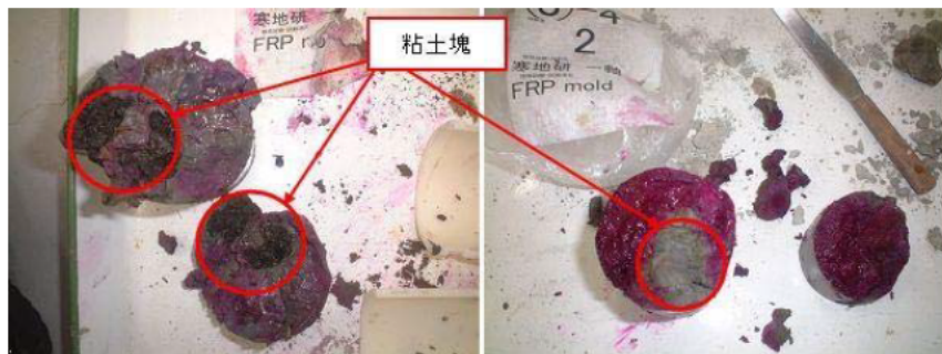
写真-5.4 粘土塊を含んだ供試体
