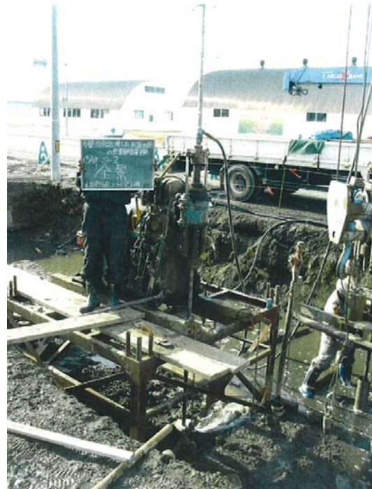
写真-4.8 トリプルチューブサウンディング作業状況
