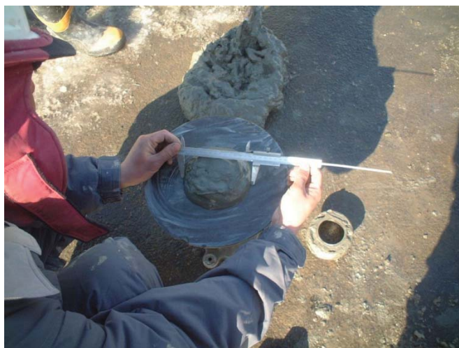
写真-1.6 テーブルフロー試験状況
