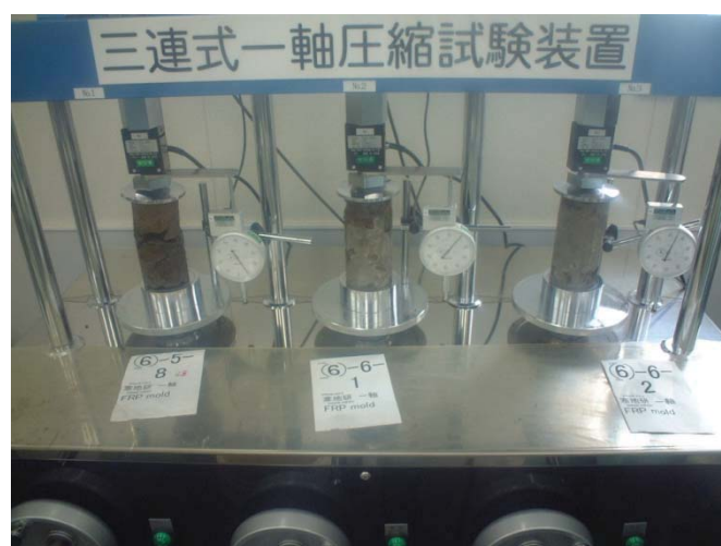
写真-1.3 一軸圧縮試験状
