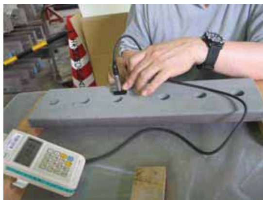
写真-3.2.3 塗膜厚の計測状況
