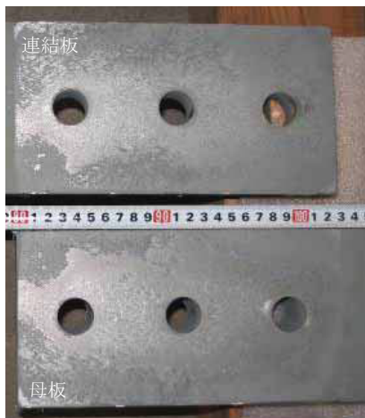
試験体 No.2-3 ナット側
