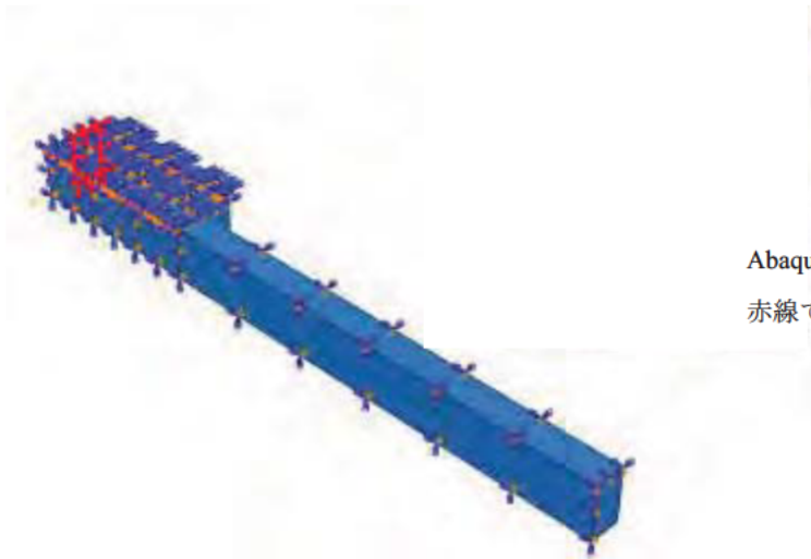
(b) 連結板の軸方向中央の対称面の拘束条件
