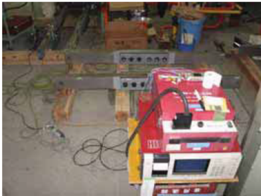
写真-3.2.5 高力ボルトの軸力計測の様子
