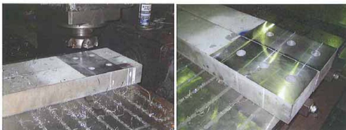
写真-3.1.2 表面機械切削加工の様子
