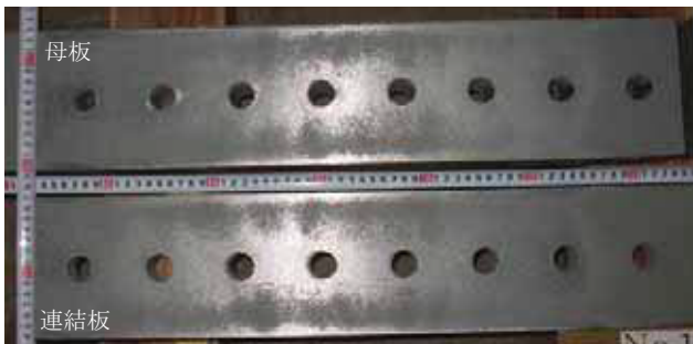
試験体 No.12-2 ナット側
