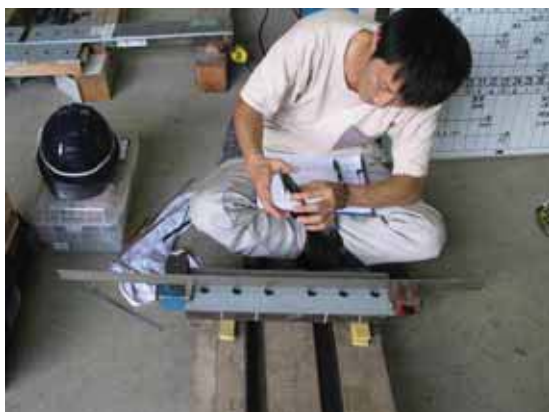
写真-3.2.1 初期不整の計測状況
