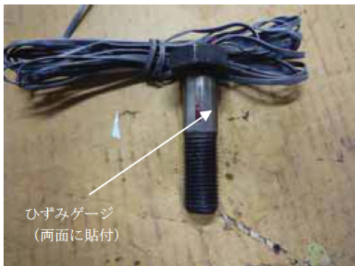
(a) ボルト軸部
