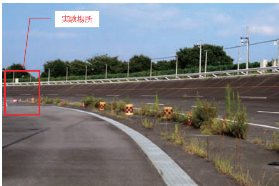
写真 3.12 斜面を模擬したバンク
