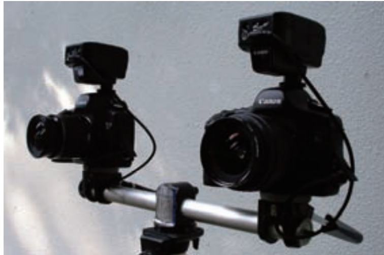
写真 2.3.4 ワイヤレスコントローラー（受信部）とカメラのセッティング
