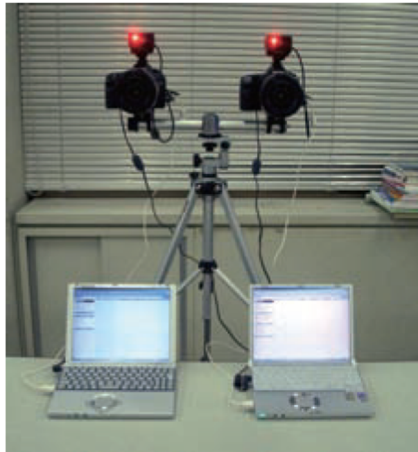
写真 2.3.3 連写性能検証時のシステム構成 (PC 保存のケース)
