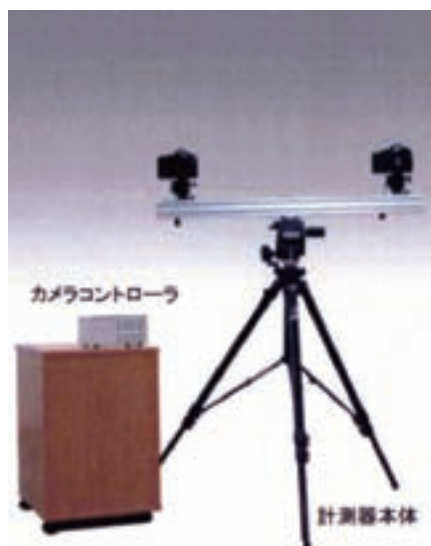
写真 2.1.1 クラボウ社製同期撮影システム
