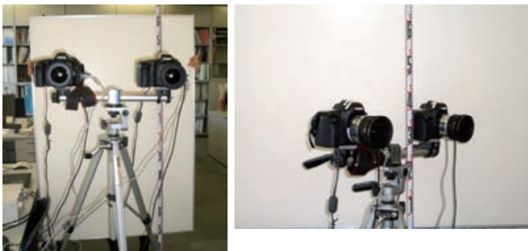
写真 2.1.2 クラボウ社製同期撮影システム (カメラ部)
