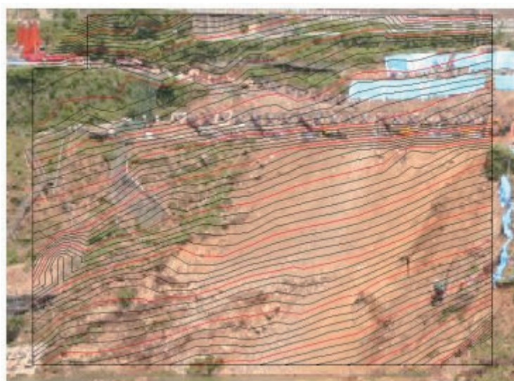
図 3.25 5mDTM データから作成したオルソコンター図表示
