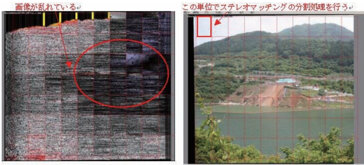
図 3.18 縦視差が発生したためにマッチングが不可能であった P 12 28 90 1 パターン
