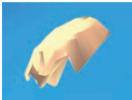
図 4.29 意図していない TIN 形状
