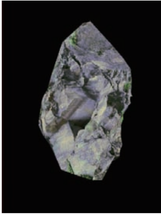
図 3.86 Kuravesによる写真計測結果（露岩部、収斂角：30°）
