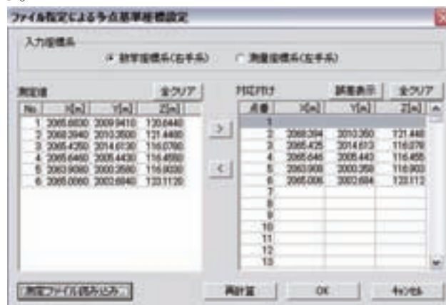
図 3.78 基準座標設定状況（最低3点以上必要）
