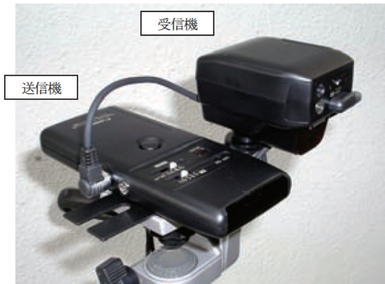
写真 2.3.1 ワイヤレスコントローラー (LC-5)
