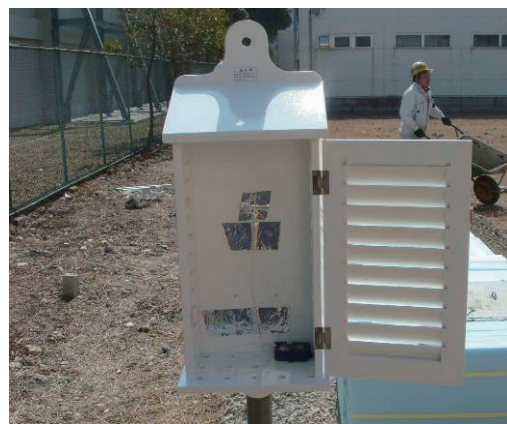
写真-3.68 百葉箱に設置した温度計測装置
