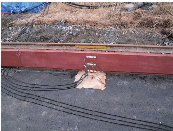
写真-3.26 ひずみ計 (縦自由縁部)
