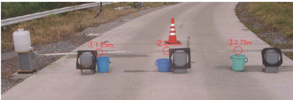
写真-3.45 散水装置の確認実験の状況
