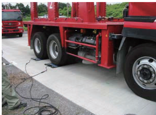
写真-3.46 輪荷重の測定状況
