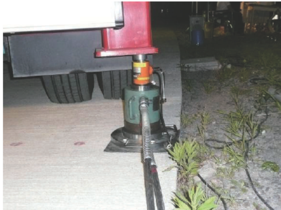
写真-3.54 自由縁部の載荷点
