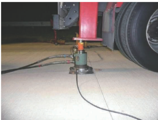
写真-3.53 目地.ひび割れ部の載荷点
