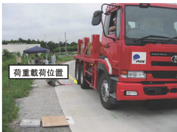
写真-3・48 静的載荷試験の試験状況
