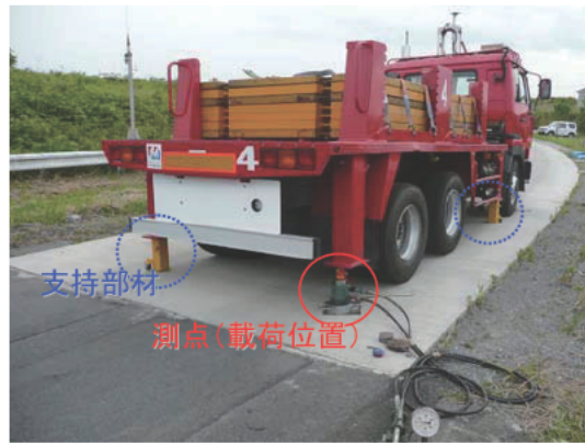
写真-3.50 支持部材と載荷点
