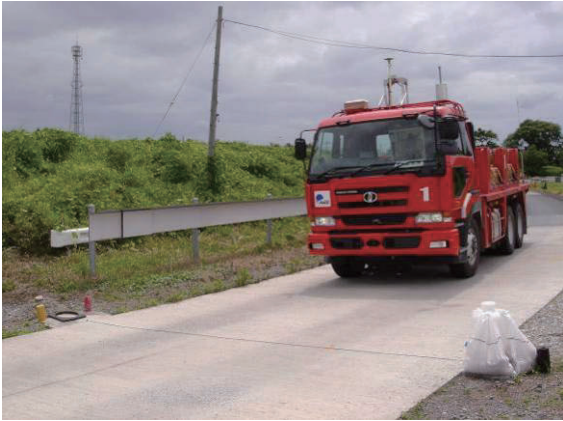
写真-3.32 促進載荷試験の実施状況
