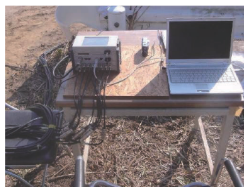
写真-3.59 収集装置 (中間層無工区)
