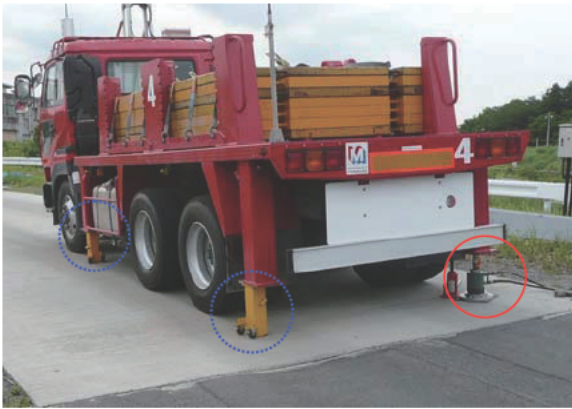
写真-3.49 静的載荷試験の全体図
