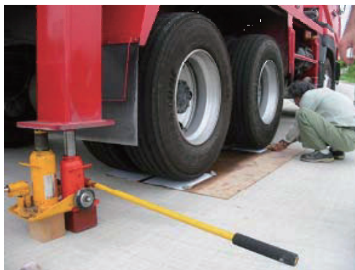
写真-3.47 タイヤ接地面積の測定状況
