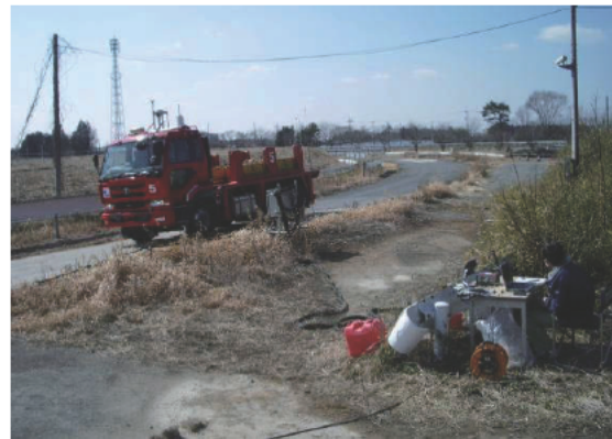
写真-3.57 動的載荷試験の計測状況 (中間層無工区)
