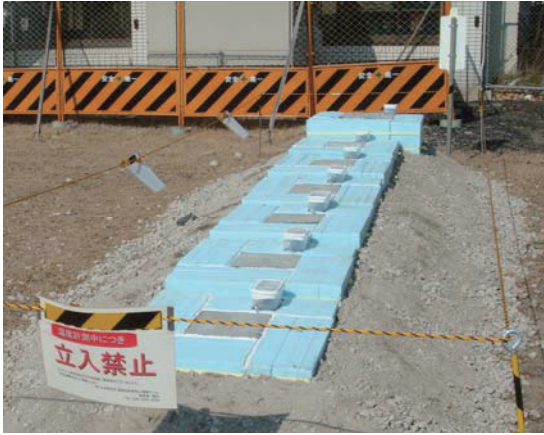
写真-3.63 コンクリート版供試体設置状況
