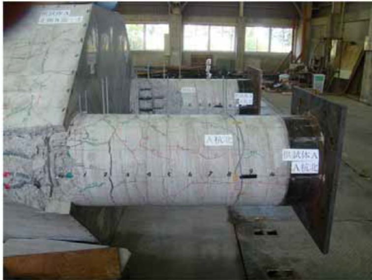
写真-4.8 実験終了後 縁端部損傷状況 (Case CPP-C-2, Pile A)
