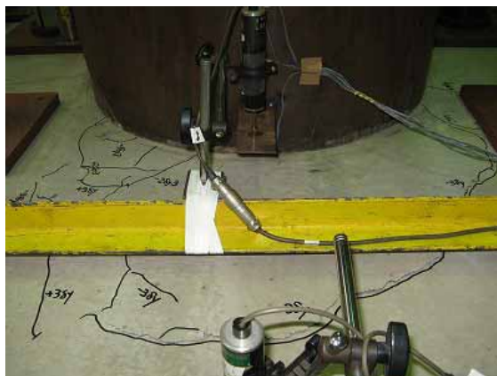
- 3d_y (1 ループ目, 東側=引張縁側)
