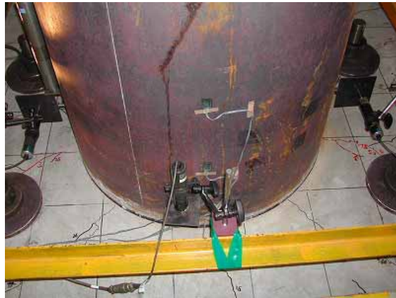
+4dy (1 ループ目, 東側=引張縁側)
