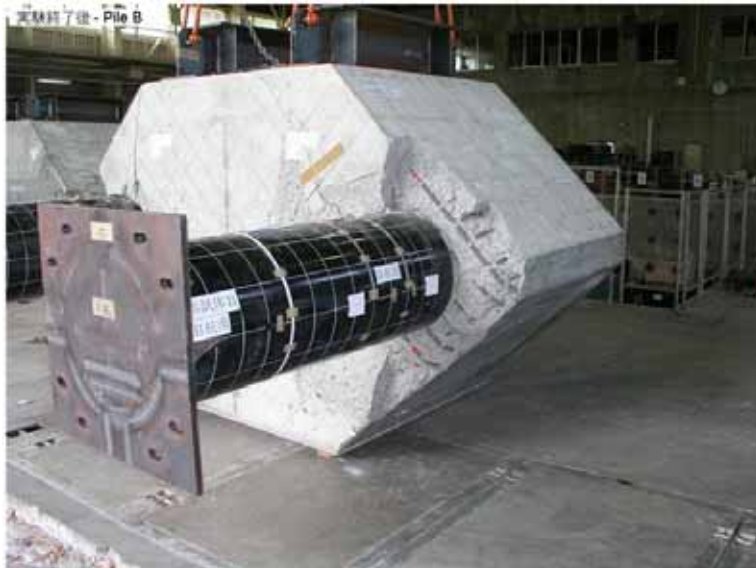
写真-4.15 実験終了後 縁端部損傷状況 (Case SPP-C-1, Pile B)
