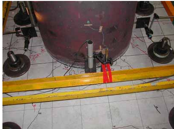
+4dy (1 ループ目, 東側=引張縁側)
