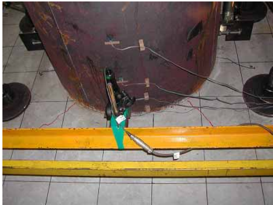
+0.5Py (1 ループ目, 西側=圧縮縁側)
