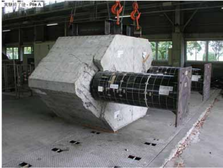
写真-4.14 実験終了後 縁端部損傷状況 (Case SPP-C-1, Pile A)
