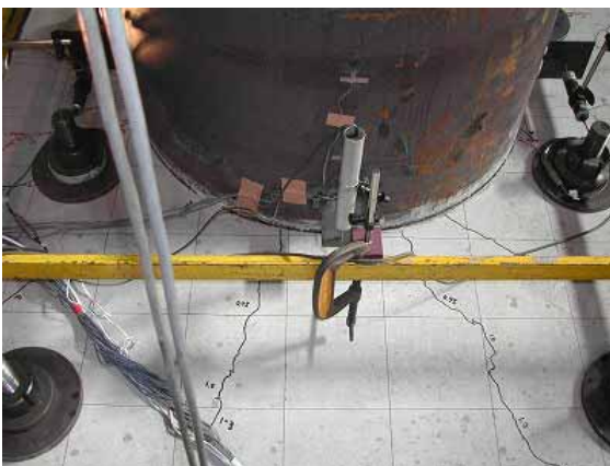
+ 4d_y (1 ループ目, 東側=引張縁側)
