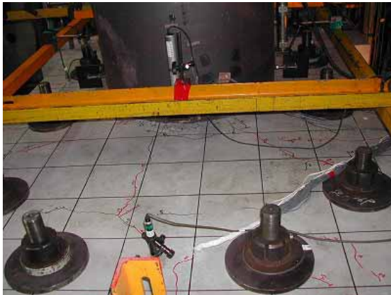
+4dy (1 ループ目, 西側=圧縮縁側)
