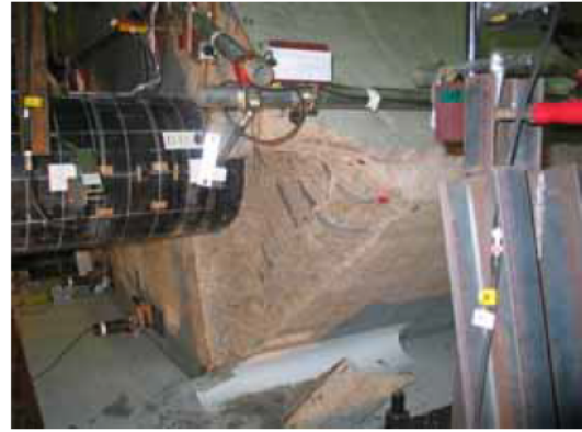
(a) 縁端側の損傷
