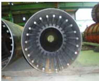
a) 杭体内鉄筋挿入 (杭製造時)
