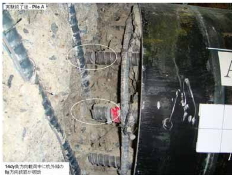
写真-4.21 実験終了後 杭体損傷状況 (Case SPP-C-2, PileA)
