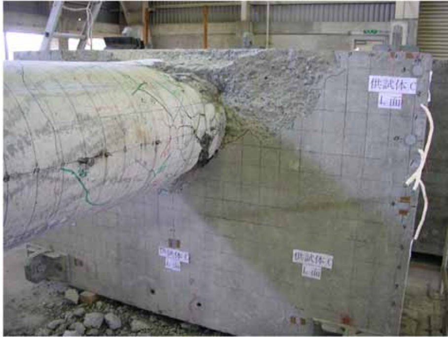
写真-2.6 実験終了後フーチング損傷状況 (Case CPP-S-3)
