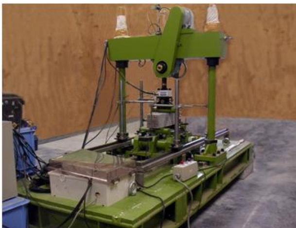
写真-1.2 破壊エネルギー試験装置
