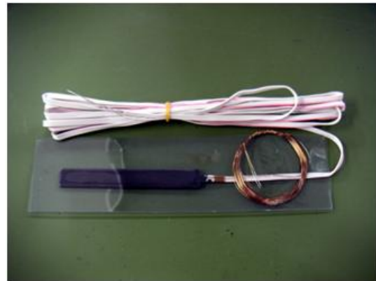
写真-5.1 埋め込み型ひずみゲージ外観
