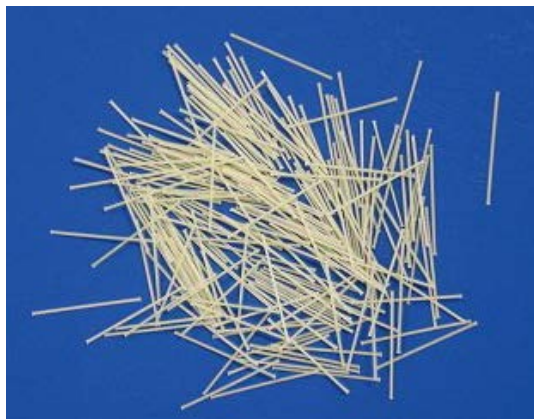
写真-2.2 PVA 短繊維 (直径 0.66 mm、長さ 30 mm)
