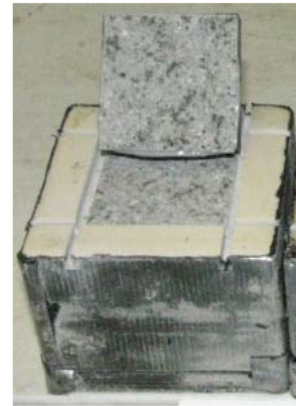
写真-15 付着強さ試験実施後の供試体 (5°C, 5日+0°C, 23日養生、300サイクル後)
