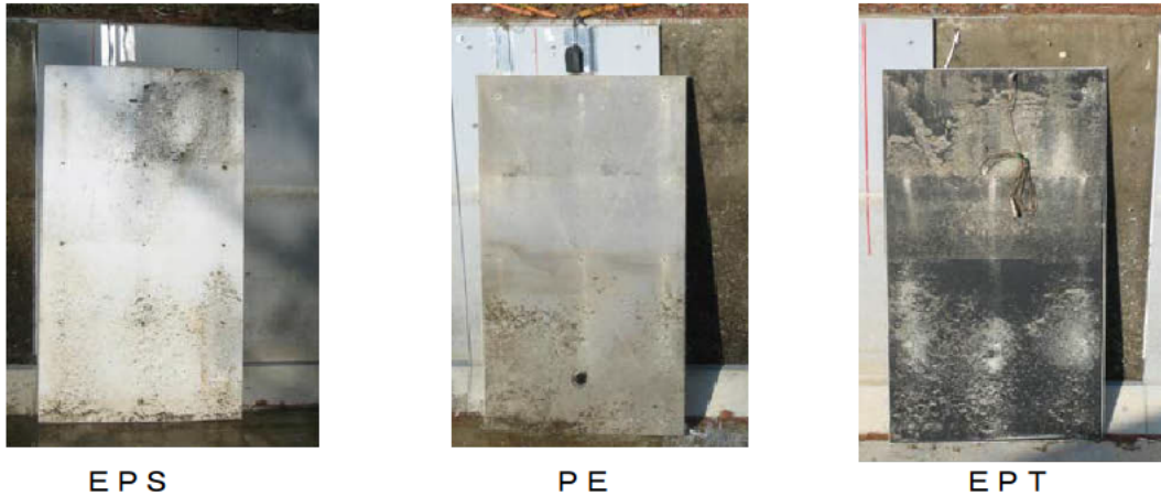
写真-11 施工から約2年後の緩衝材（176mm×100mm）の状況
