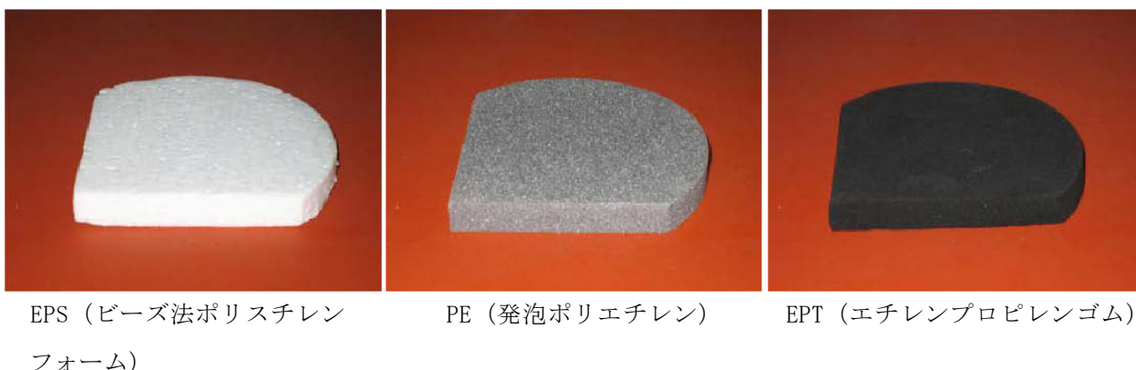
写真-4 試験施工で使用した緩衝材（t=10mm）
