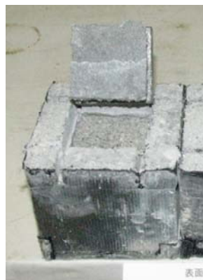
写真-16 モルタル系の付着強さ試験実施後の供試体 (5°C, 5日 + 0°C, 23日養生、300サイクル後)
