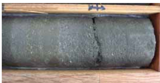
写真4.7 深度29.9m付近の粗粒砂岩（白い斑点状の部分が貝殻片）
