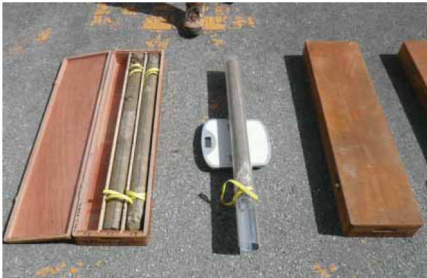
写真 4.11 ボーリングコア重量測定状況
