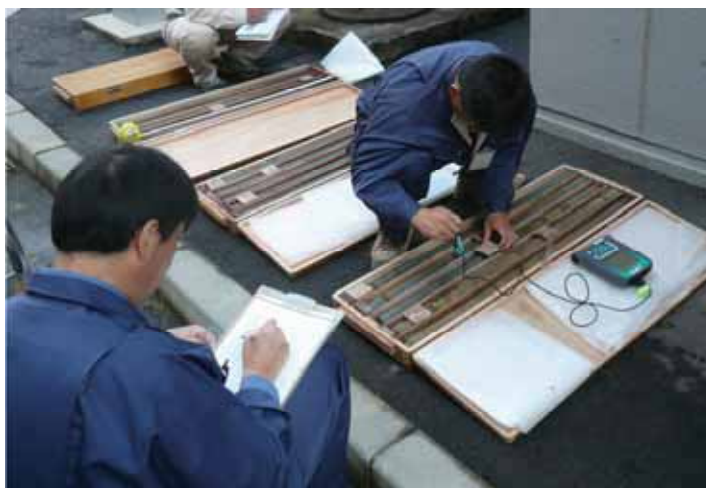
写真 4.12 エコーチップ反発硬度計測状況
