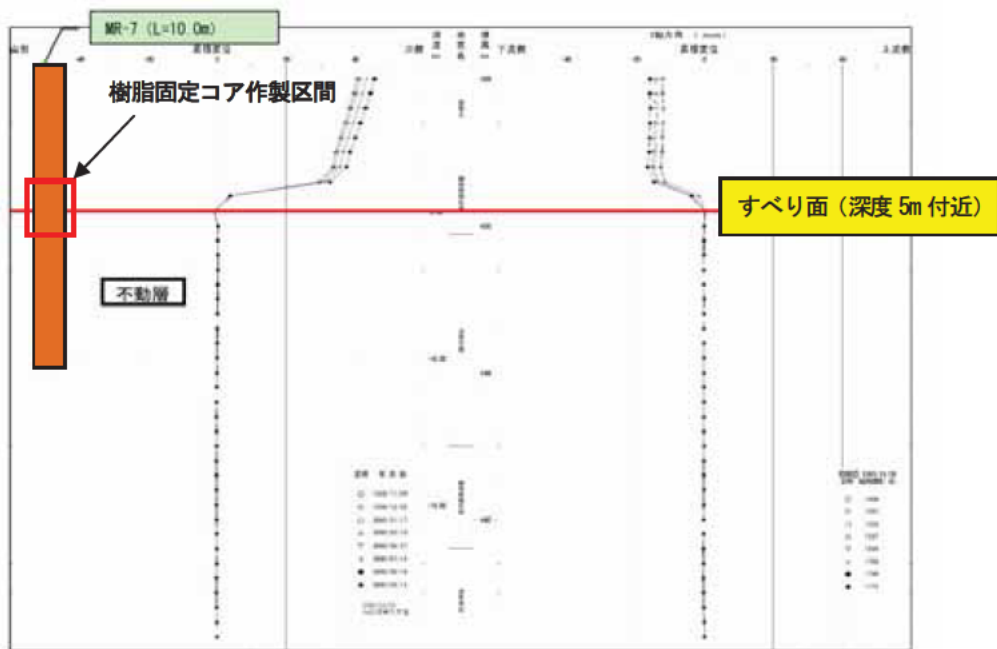
図 3.6.4 M7 孔内傾斜計観測結果図 (1999 年 11 月～2000 年 11 月) 2)
