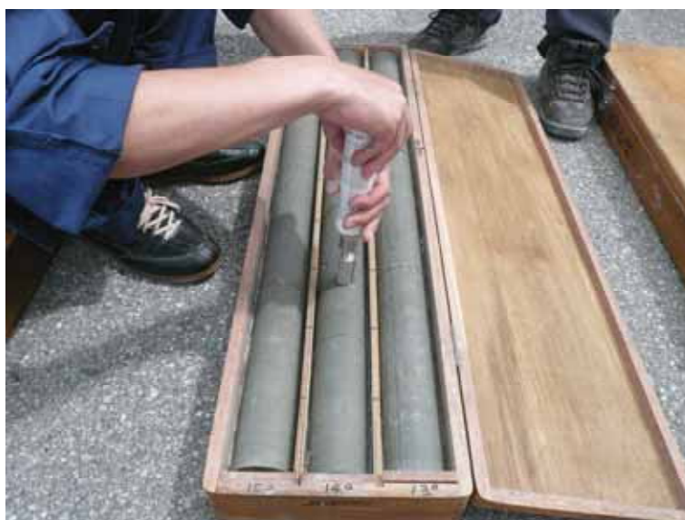
写真 4.13 針貫入試験状況
