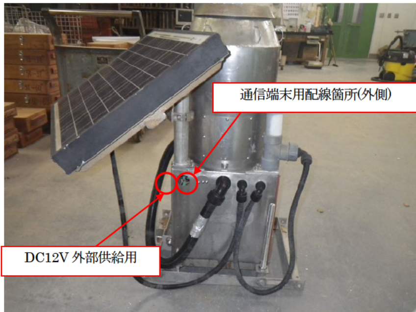
図 8 通信端末、外部電力供給箇所
