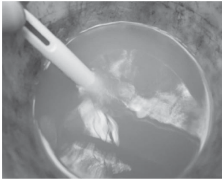
写真 3.4 洗浄時の戻り水の濁り状況
