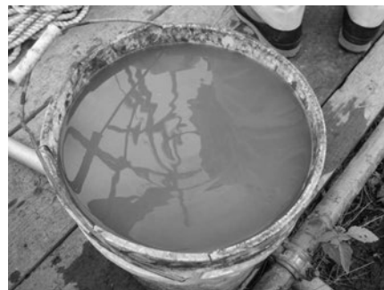
写真 3.3 孔内の濁り水
