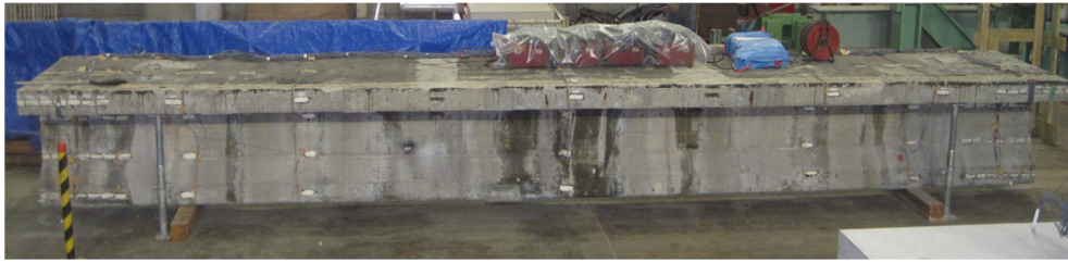
写真 4.1.4 ポストテンション桁載荷前の状況
