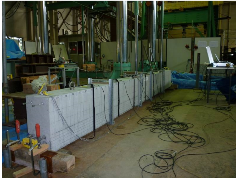
写真1.1 PCはり供試体
