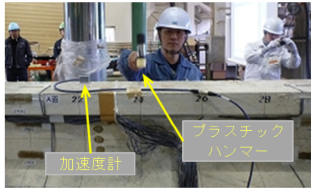
写真 4.1.2 ハンマによる加振状況
