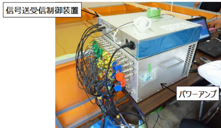
図-10 パワーアンプと信号送受信制御装置
