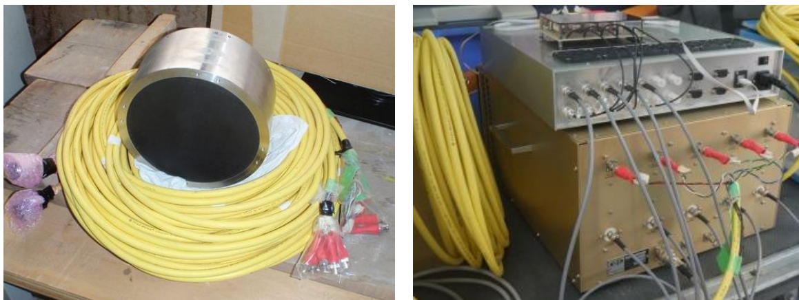
図-17 パラメトリック送受波器（左）とパワーアンプ（右）
