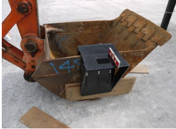
図-27 ソナー昇降装置取付金具のバックホウへの取付状況
