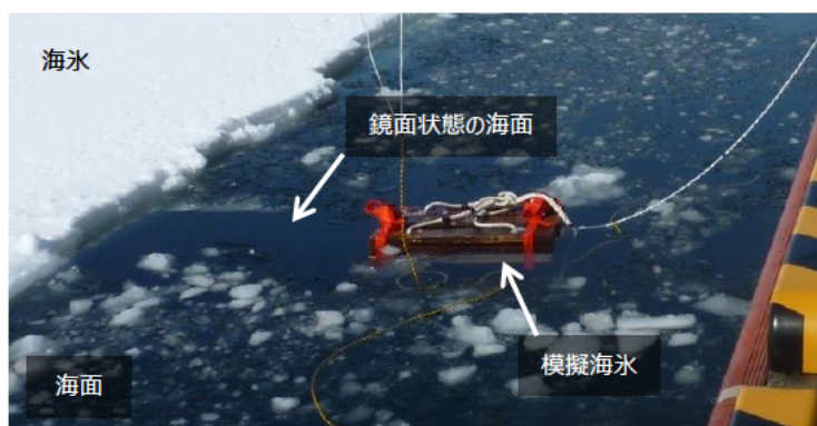
図-53 模擬海氷計測状況 (図-51 上のデータを計測した時刻とほぼ同じ時刻に撮影)
