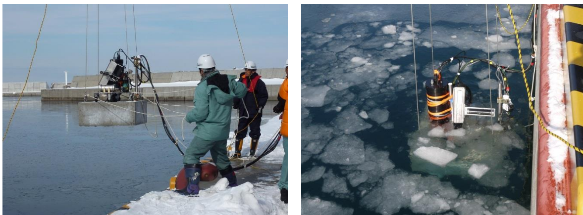
図-43 計測装置の海中への投入
