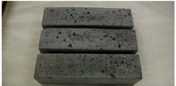
図-7 凍結融解試験における相対動弾性係数、質量変化率及びスケーリングの状況 (1)
