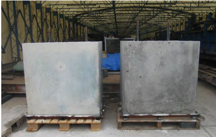
撮影: 材齢 2 日目 (型枠脱型直後)
