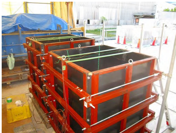
写真-6 試験に用いた鋼製型枠（1m角）
