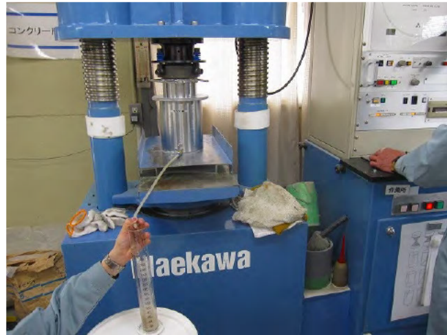
写真-7 加圧ブリーディング試験状況
