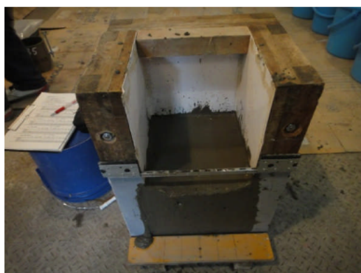
写真 4.5.1.1 ボックス型枠
