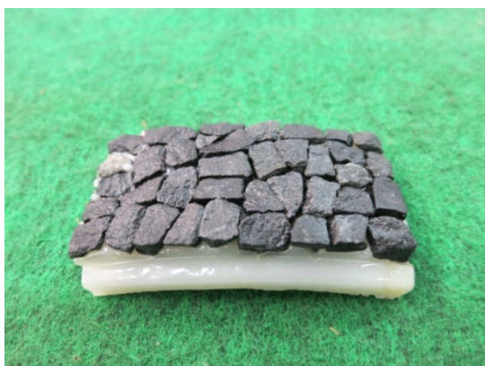
写真 3.3.2.3 骨材を敷き詰めた状態
