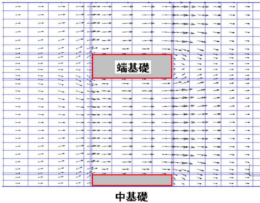
図-3.1.20(3) 三次元有限要素解析による盛土高 4.0m における基礎周辺地盤の動き : Case3
