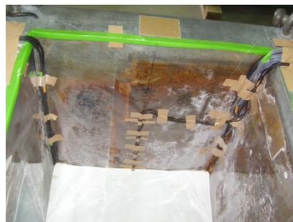
写真-2.1.4 間隙水圧計の設置
