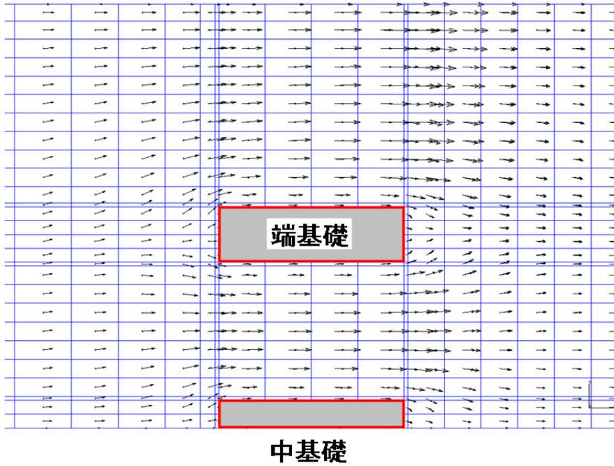
図-3.1.20(2) 三次元有限要素解析による盛土高 4.0m における基礎周辺地盤の動き : Case2
